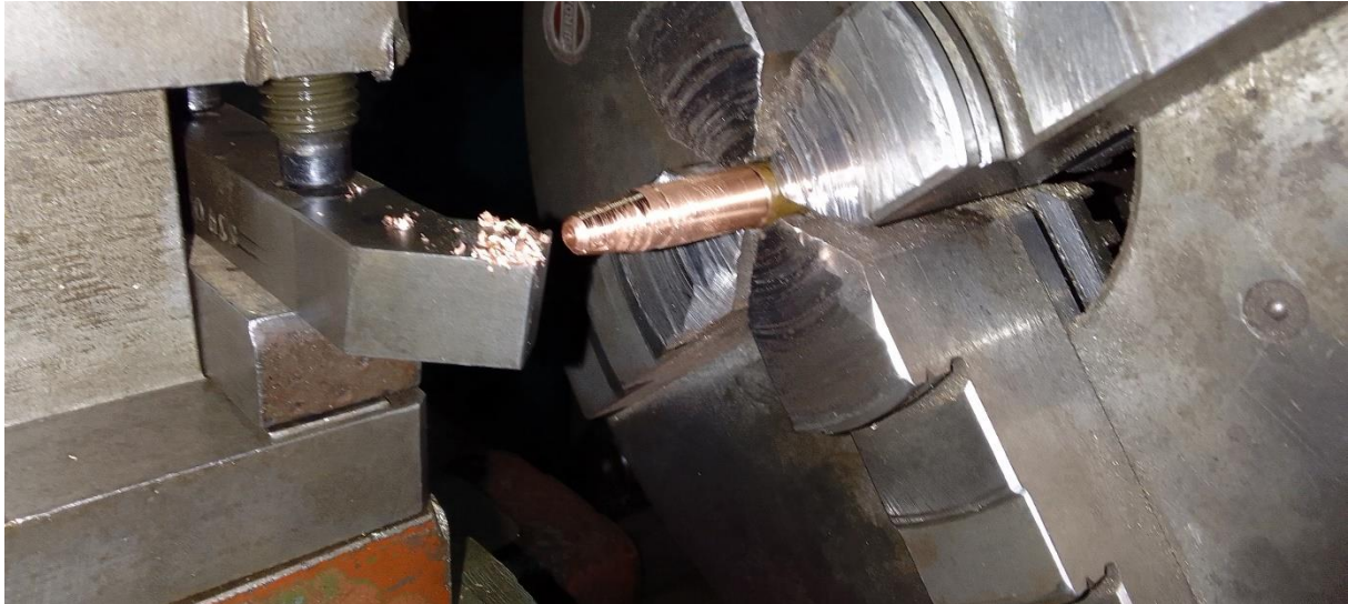
Figure II.10 : usinage des électrodes en cuivre
