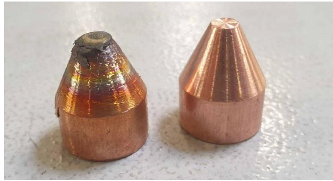
Figure I.12 : Exemple d'une dégradation des électrodes. [12]
