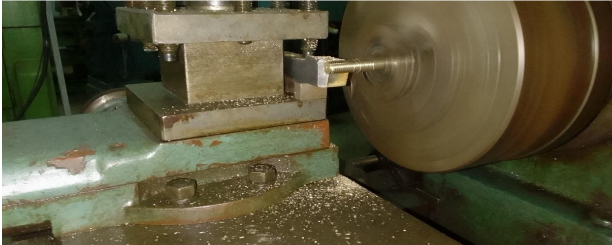
Figure II.7 : usinage Des électrodes en bronze
