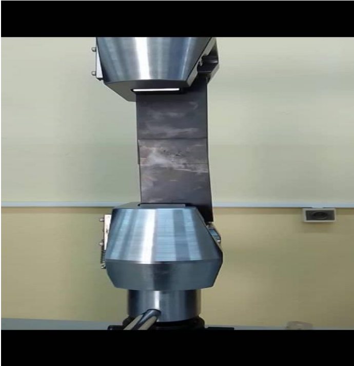
Figure II.14 : Essai de traction sur une machine à capacité de 50 kN.
