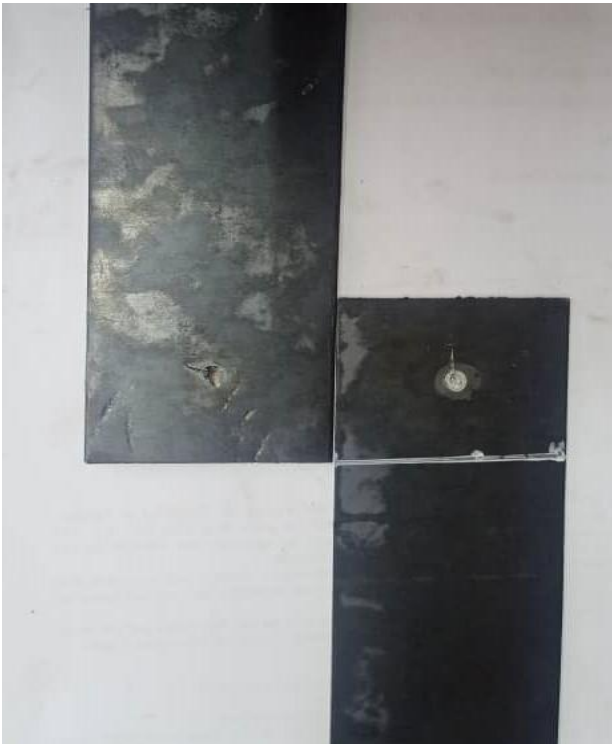
Figure II.15 : Eprouvettes rompues après l’essai de traction.
