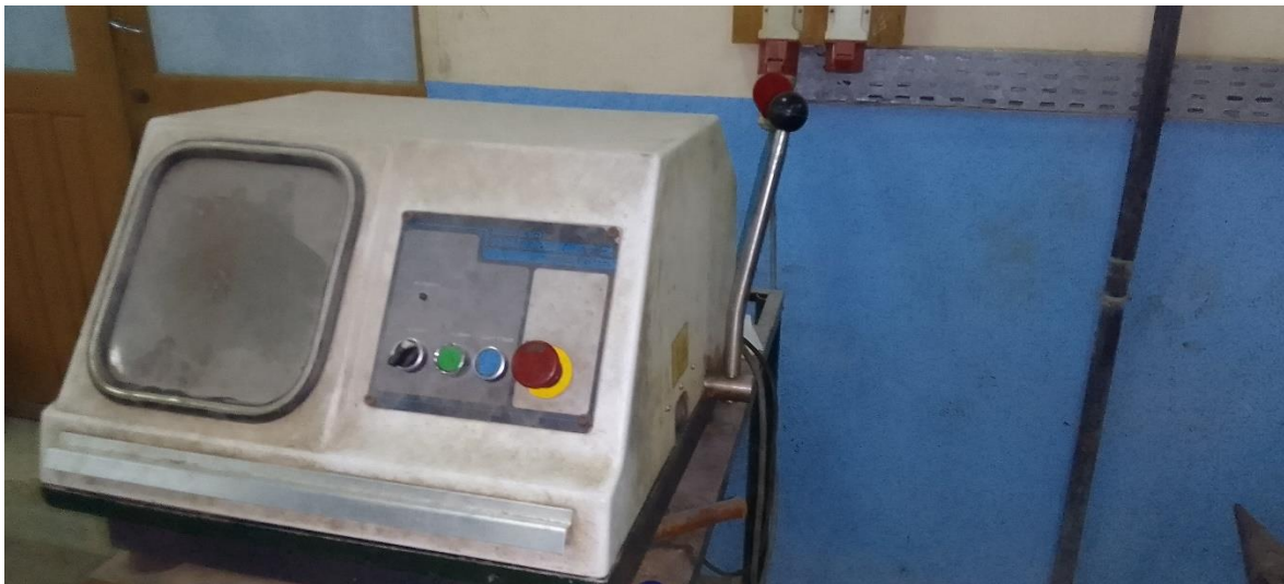
Figure II.3: Une tronçonneuse abrasive manuelle BULER ABRASIMET 2.
