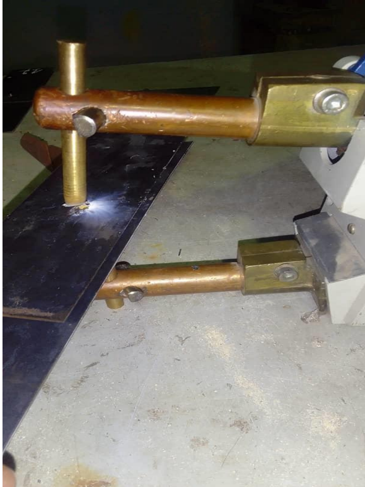
Figure II.9 : soudage des plaques avec électrode en bronze.
