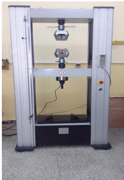
Figure II.5 : Machine automatique d'essai de traction modèle WDW-50 capacité 50KN.
