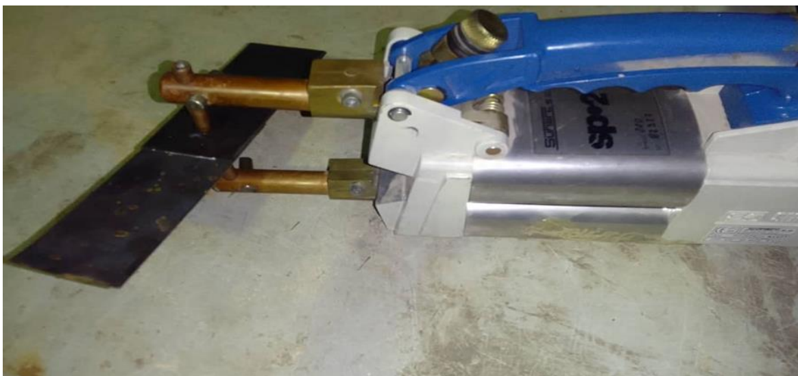
Figure II.12 : soudage des plaques avec les électrodes en cuivre.
