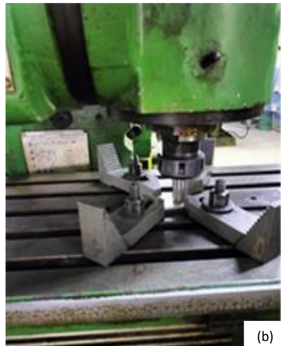
figure III.11.a) Fraiseuse universelle modifiée de type FH 1.6 ALMO, (b) Pièce à souder Fixées avec des brides de serrage.
