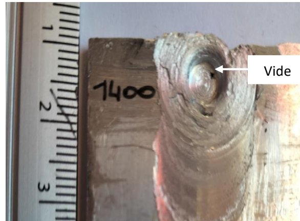
Figure IV.9. Défaut tunnel interne.
