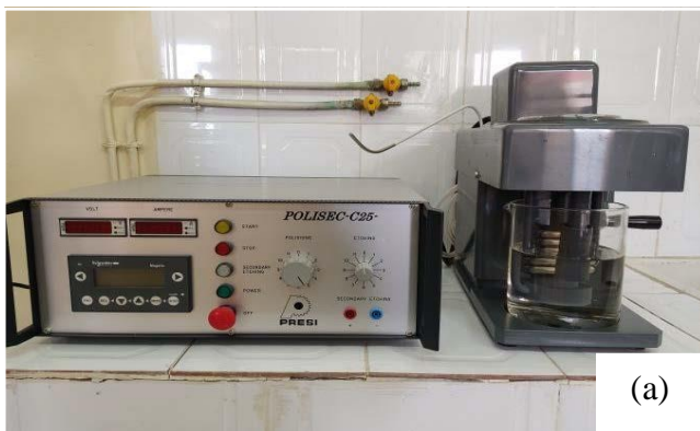
Figure III.15. (a) Polisseuse électrolytique utilisée de type POLISEC C25 / (b) Epreuve
