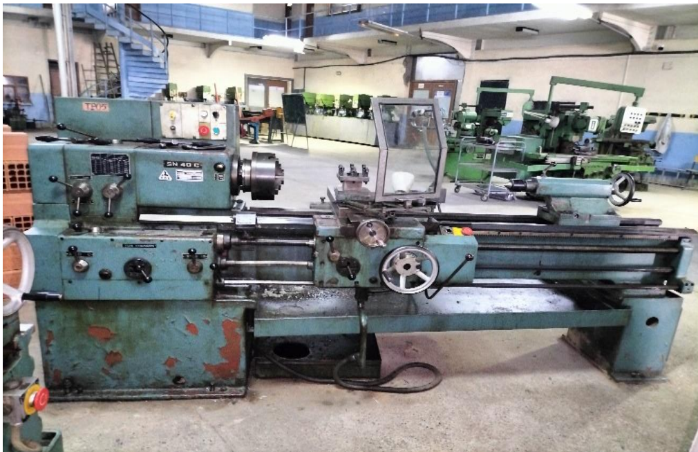
Figure III.9. Tour conventionnel type SN 40 C du hall de technologie.
