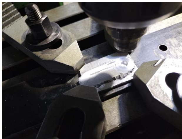
Figure III.12. Exécution de l'opération de soudage par friction et malaxage
