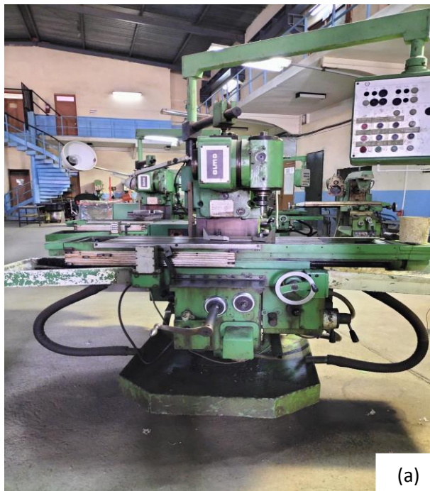
figure III.11.a) Fraiseuse universelle modifiée de type FH 1.6 ALMO, (b) Pièce à souder Fixées avec des brides de serrage.
