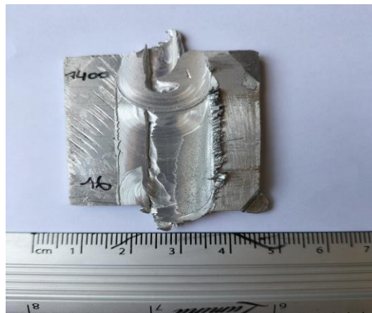
Figure IV.8. Défaut flux de métal a racine du cordon de soudure
