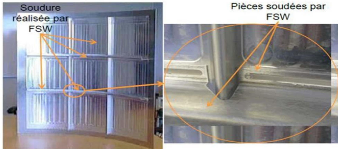
Figure I.15. Voilure d'avion soudée par FSW [32]
