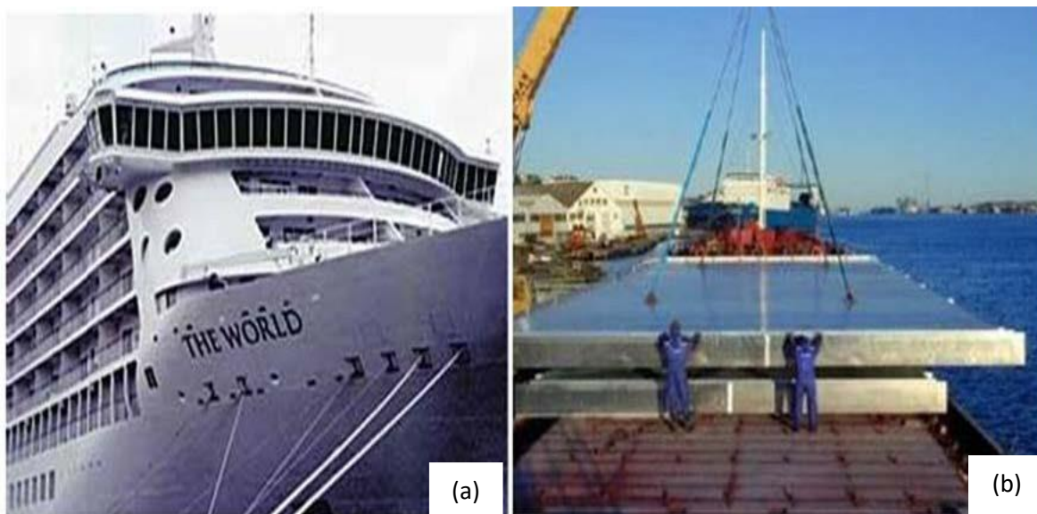
Figure I.16. (a) Bateau en aluminium construit en utilisant FSW / (b)Panneaux préfabriqués (Hydro Marine Aluminium) destine au pont du bateau de croisière [33].
