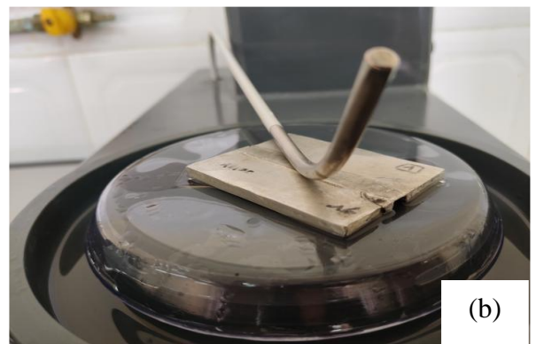
Figure III.15. (a) Polisseuse électrolytique utilisée de type POLISEC C25 / (b) Epreuve
