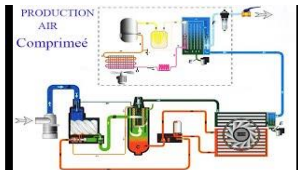
Figure III-9 : système de refroidissement de l'air comprimé
