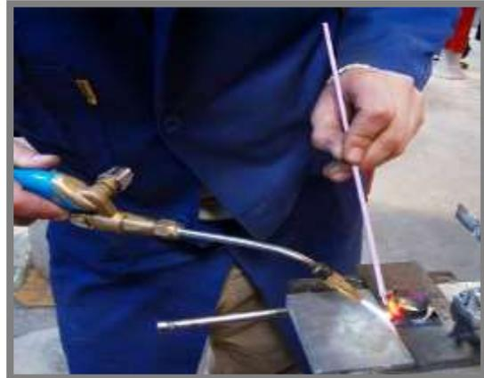
Figure I.3 – Procédés chimique au chalumeau.
