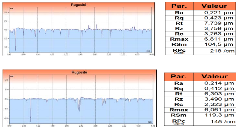
Figure III.10 des exemple de rugosité de face intérieure
