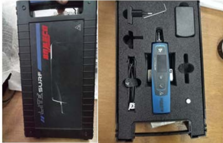
Figure III.6 Rugosimètre LITE SURF.
