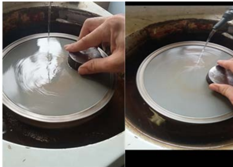
Figure III.3 Le polissage mécanique
