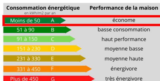
La valeur totale des besoins énergétiques de la maison, à  $36 \text{ kWh}/\text{m}^2$ , est inférieure au seuil de  $50 \text{ kWh}/\text{m}^2$  défini par l'échelle de consommation énergétique. Selon cette norme, elle peut être catégorisée dans la classe A, ce qui indique qu'elle est très économe en énergie.
