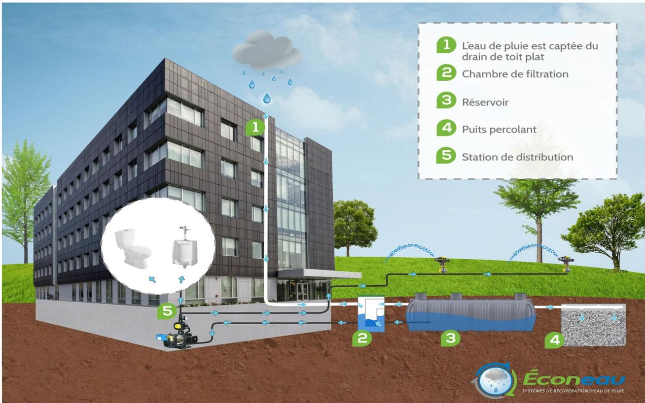
**Figure 39** : photo explicative d'un système de récupération d'eau
