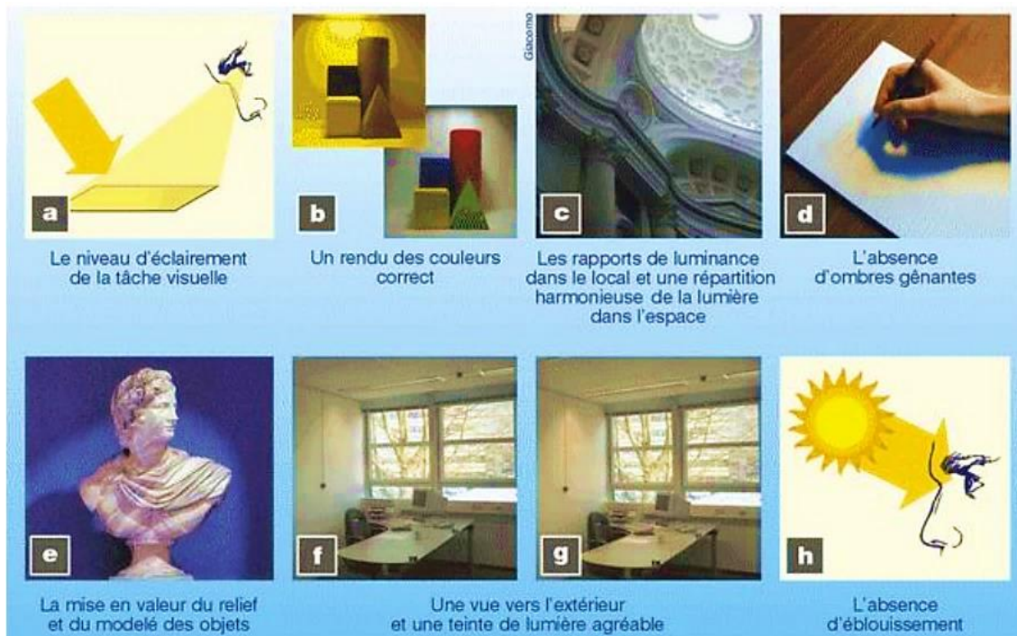
Figure 18 : les paramètres de confort lumineux dans un local (source : Liébard.A, De Herde.A, 2005).
