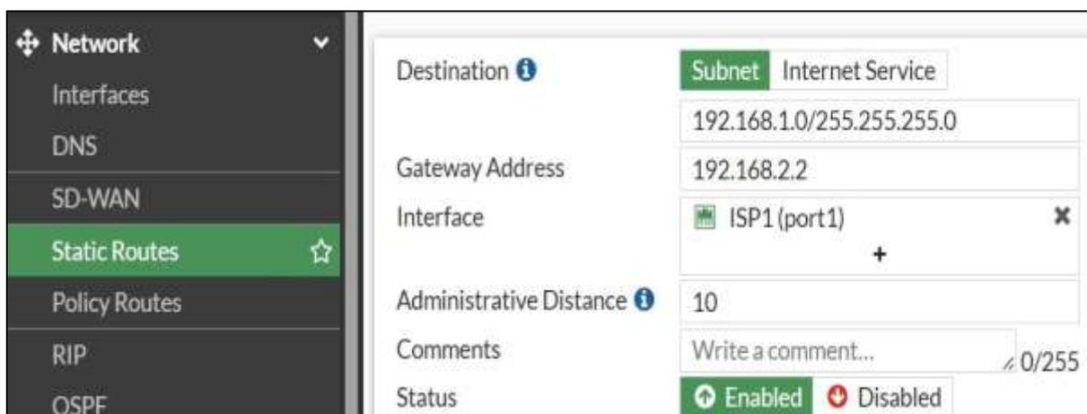
Figure 36 : Configuration de routage statique
