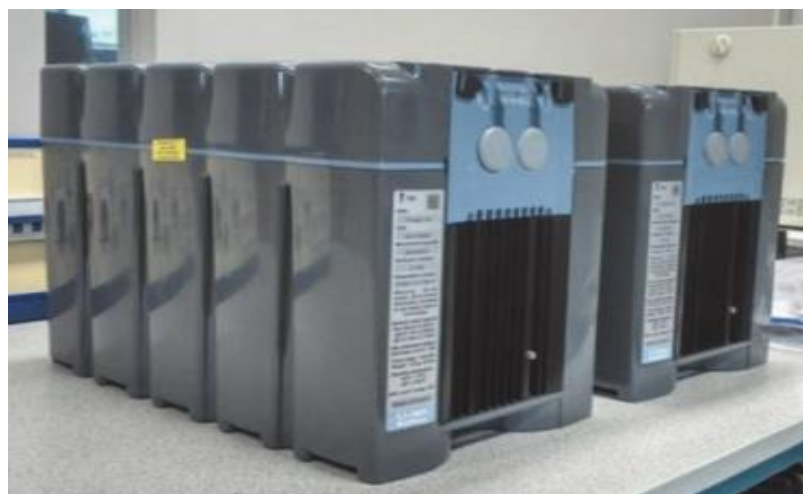
Figure II.11 : Batteries Li-ion Saft : tension nominale 48V, courant de charge 32A, courant de décharge 44A, énergie 3900Wh, énergie massique 130Wh/Kg (L2EP HEI Lille).
