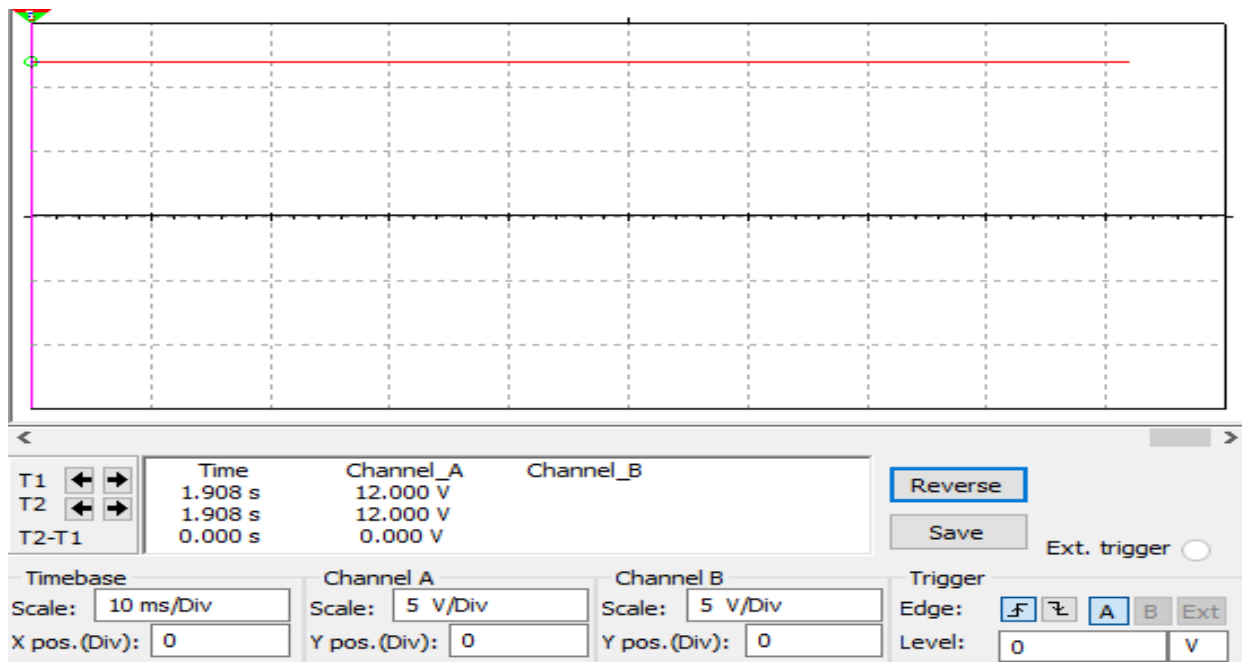
Figure IV.3 : L'allure de la tension du générateur PV, 12V.
