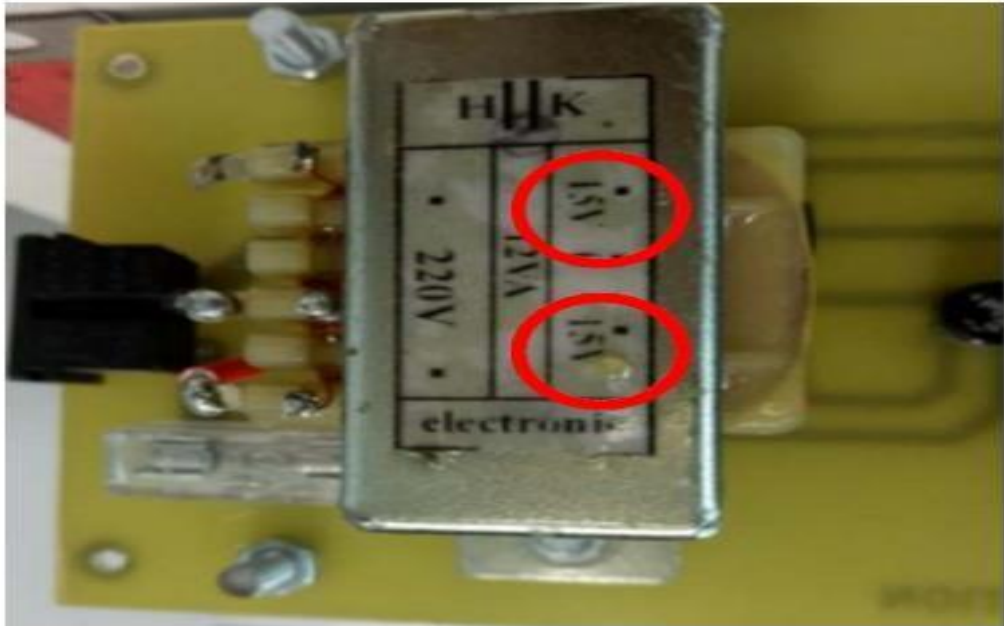
Figure III.13 : Transformateur ou point milieu (15V à 230V) [26].
