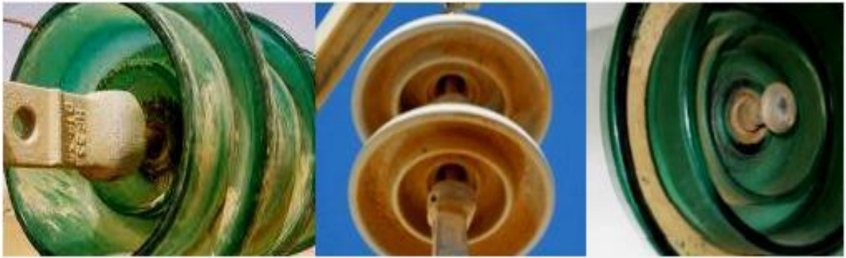
Fig. II. 1 : Couche de pollution sur des isolateurs en silicone et en verre [49]
