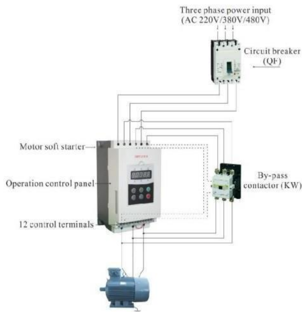
Figure II-24 Démarrage avec démarreur
