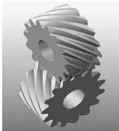
Figure I-9 : Engrenage gauche
