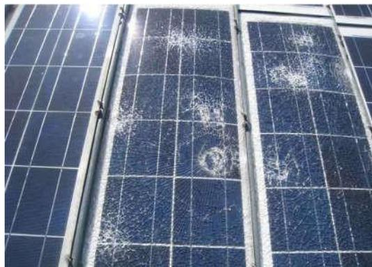
Figure II\_01: cellules photovoltaïques défectueuses
