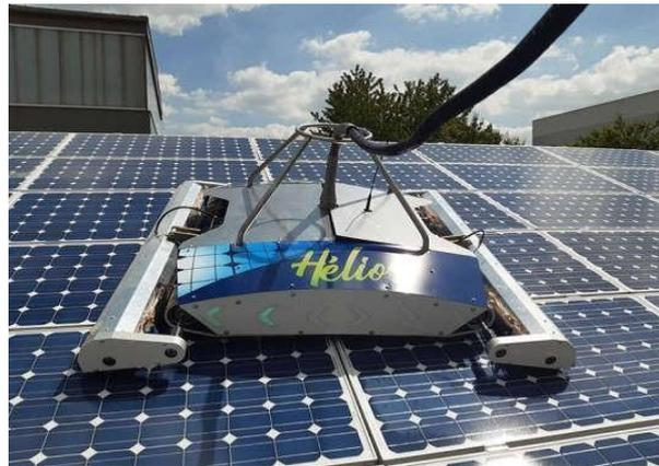
**Figure II\_16:** Nettoyage robotique.
