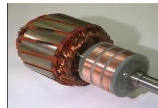
*Figure I.4 Rotor bobiné de MAS*
