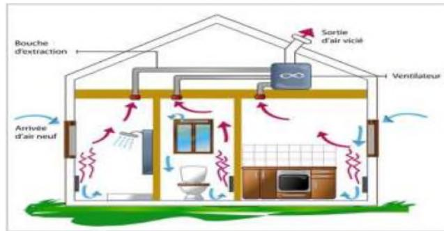
Fig I.5 Ventilation mécanique contrôlée simple flux [17]
