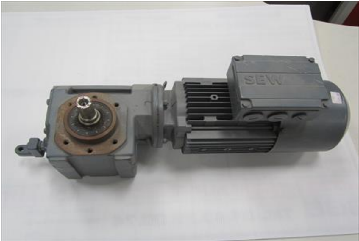
Figure 4: Photo réelle du moto-variateur SEW SA47/T
