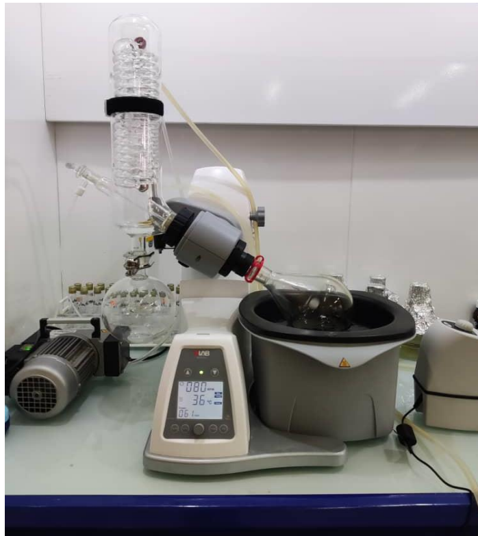
Figure 14 : photographie Originale de la préparation de l'extrait par l'évaporateur rotatif.
