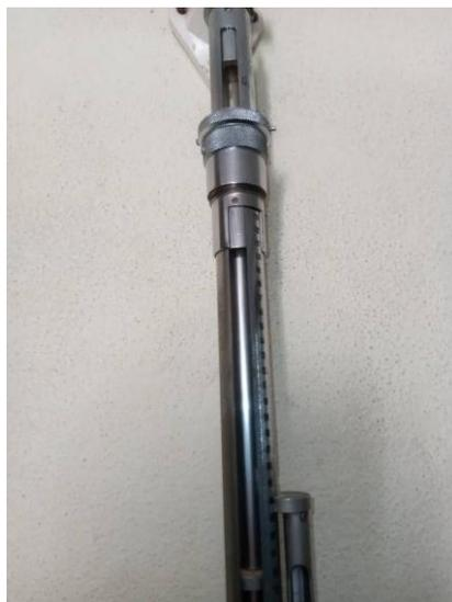
**Figure II.8** baromètre à mercure utilisé dans la mesure de pression.
