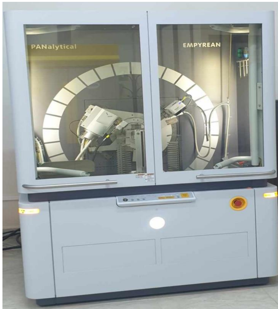
Figure.III.31: Vue d'une installation de diffraction avec les rayons X.
