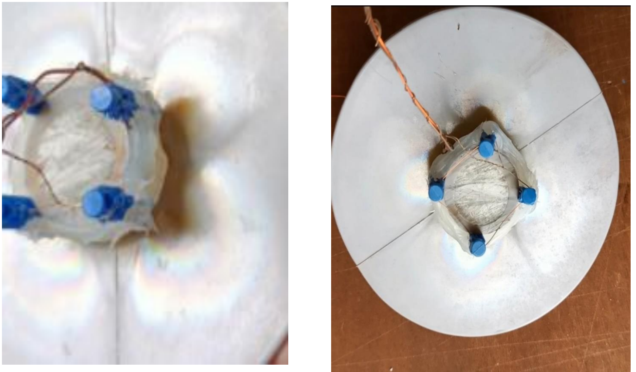
Figure.III.33: Observation visuelle de la décoloration des échantillons en silicone après vieillissement (phénomène iridescence).
