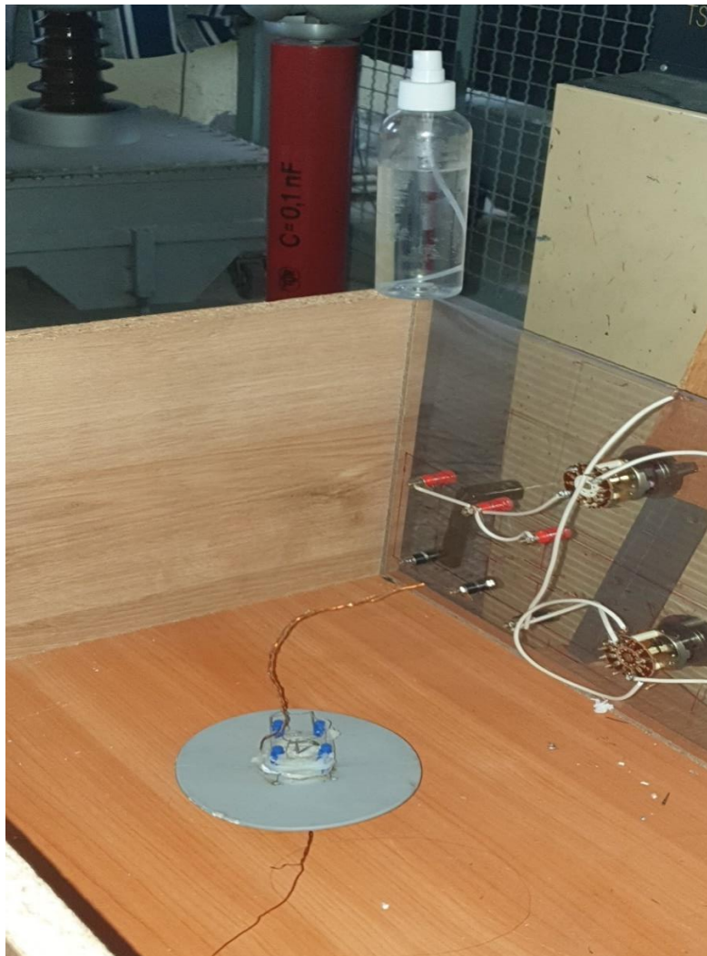
Figure.III.19: Dispositif expérimental pour la reproduction de la pollution artificielle.
