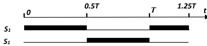
Figure II. 2 Signaux de commande de Tr1 et Tr.
