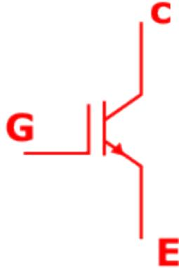
FIGURE I-8 – symbole d'un Transistor IGBT
