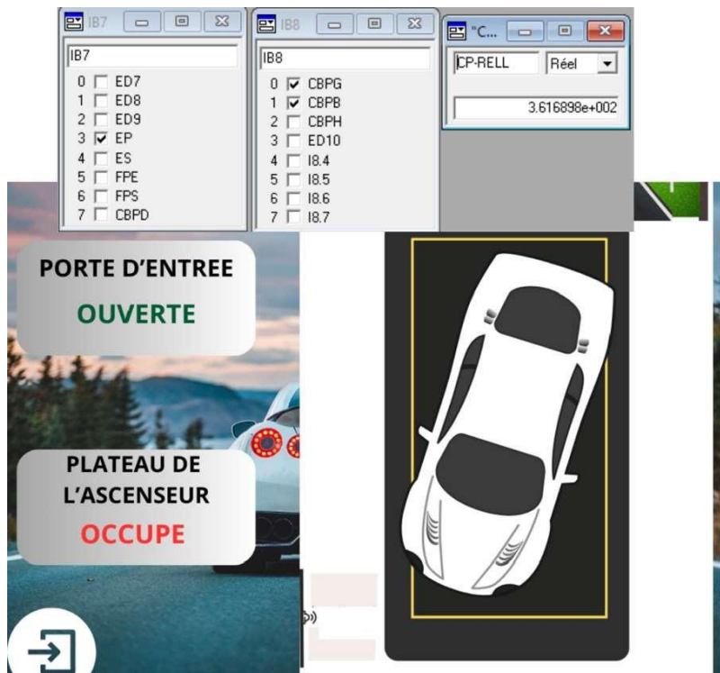
Figure IV- 26 Vue lorsque le plateau est occupé et la voiture mal positionnée
