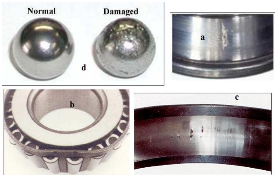
Figure I.06 : Défauts des roulements à billes. (a) sur la bague interne; (b) sur la cage; (c) sur une bille et (d) sur la bague externe. [5]
