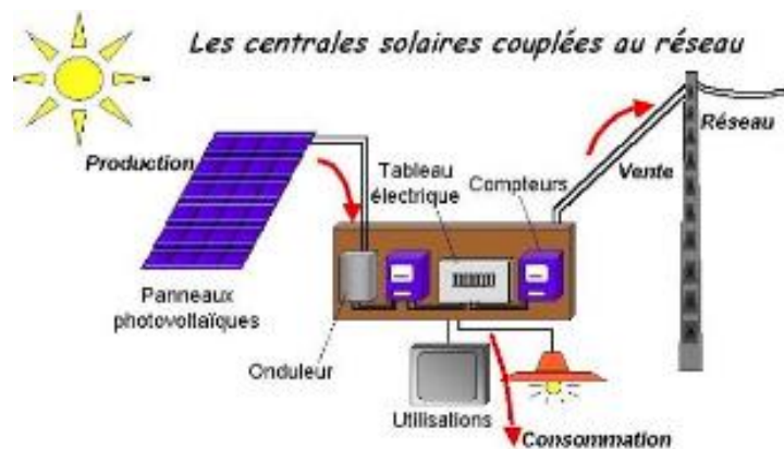
Fig. III.9: Système PV raccordé au réseau.
