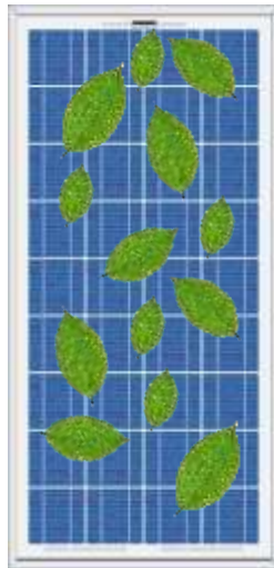
Figure (III-19) : Application de feuilles d'arbres sur le panneau PV.
