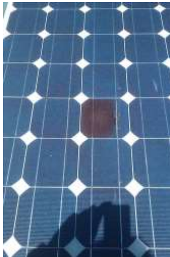
Figure (III-3) : Illustre le résultat lorsqu'une cellule en silicium s'oxyde.
