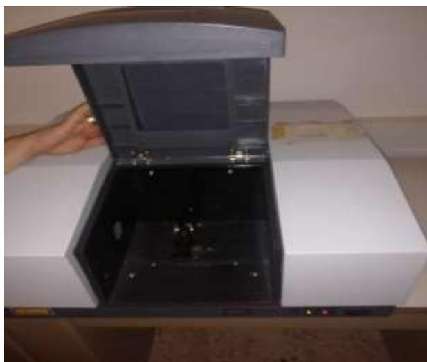
**Figure II.7** : Appareil spectrophotomètre de type SHIMADZU FTIR-8400 (**Photo originale**)
