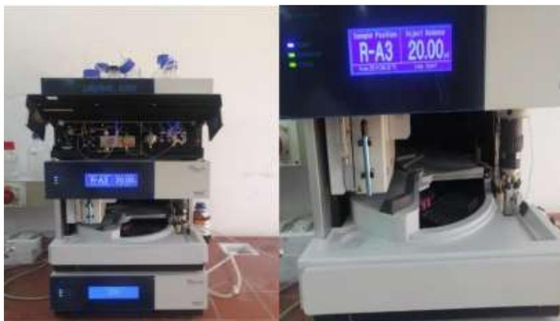
**Figure II.9 :** Chromatographie en phase liquide à haute performance(HPLC) (Ultimate 3000)
