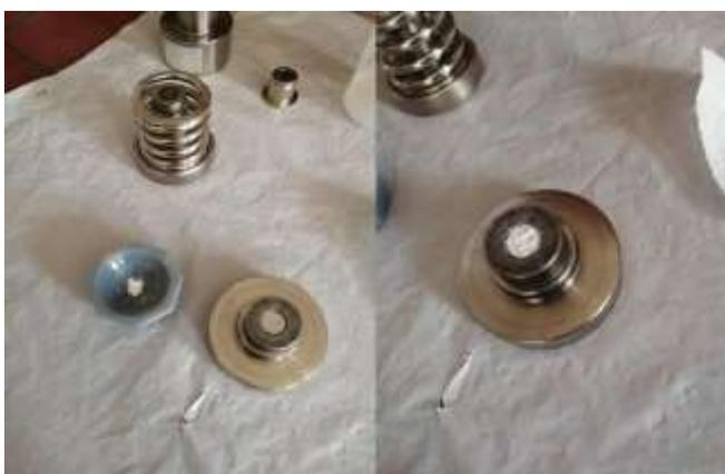
**Figure II.6** : Confection des pastilles (échantillon + KBr) pour l'analyse IR (**Photo originale**)
