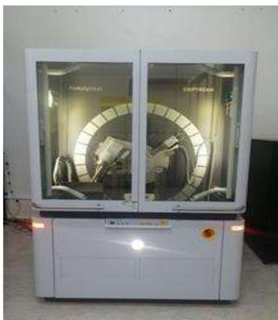
Figure II.8 : Diffractomètre PANalytical EMPYREAN (Photo originale)
