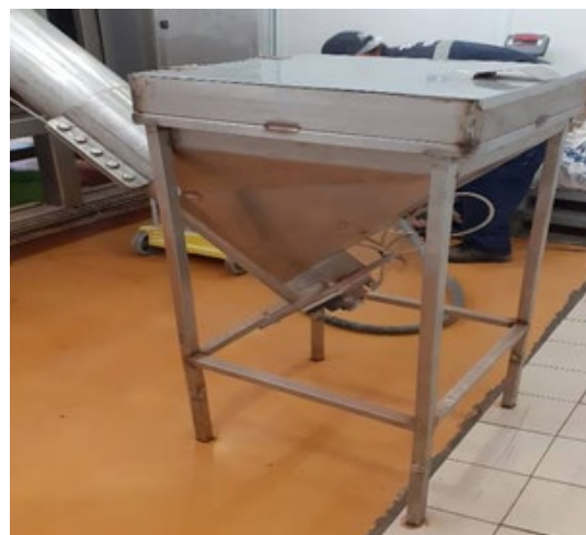
Cuve de remplissage
