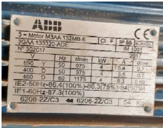
Figure II.3 : Images réelles de la plaque signalétique et du moteur utilisé.
