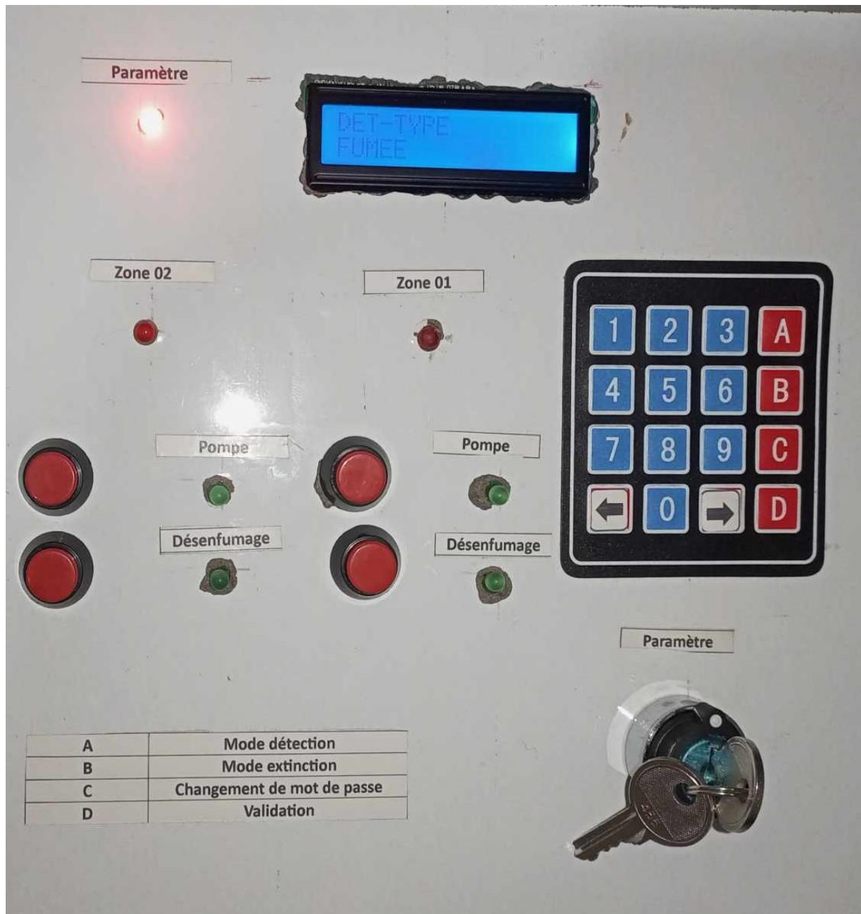
Figure III.7. La centrale de commande en mode paramétrage.
