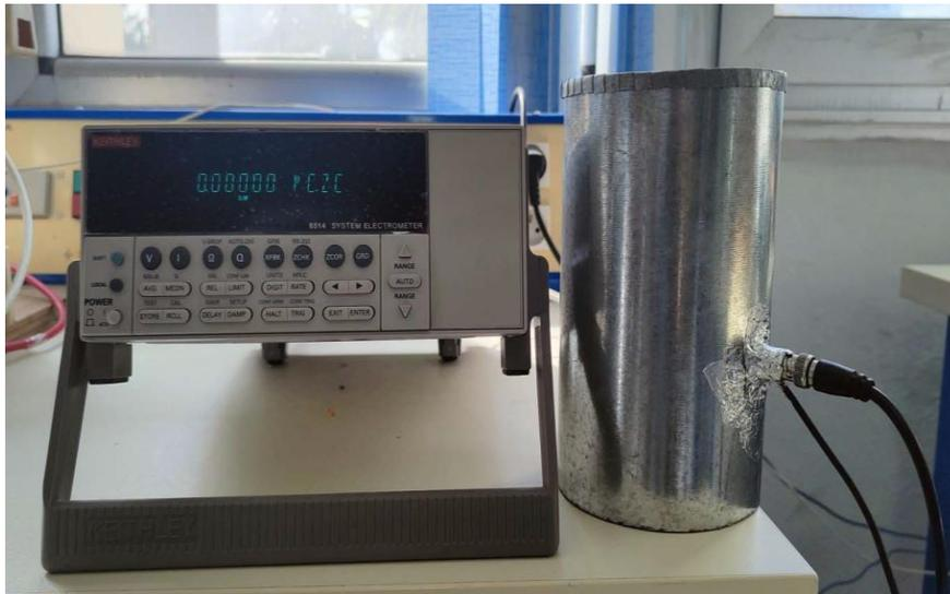
**Figure IV.3.** Photographie du montage de mesure de la charge électrique: (1) Seau de Faraday, (2) Electromètre numérique (Keithley - modèle: 6514).
