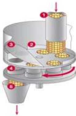
Figure 2- principe de fonctionnement du doseur [11]
