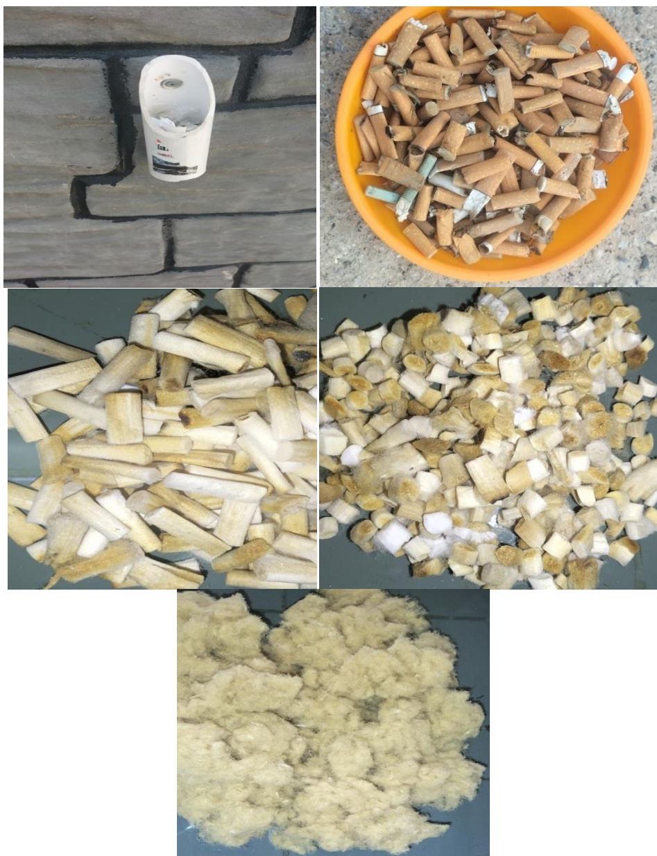
Figure II.6: Etapes suivies pour l'obtention de la mousse de mégot de cigarette.
