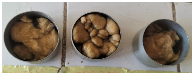
Figure II.7 : Essai d'absorption d'eau des filtres.
