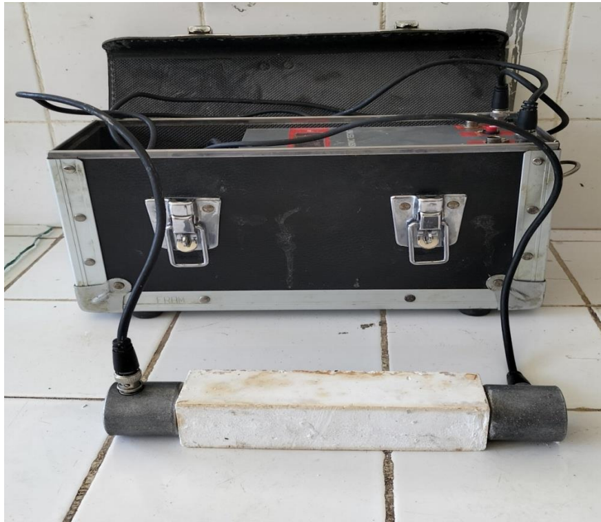
Figure III.11 : Mesure de la vitesse de propagation des ondes ultrasoniques.
