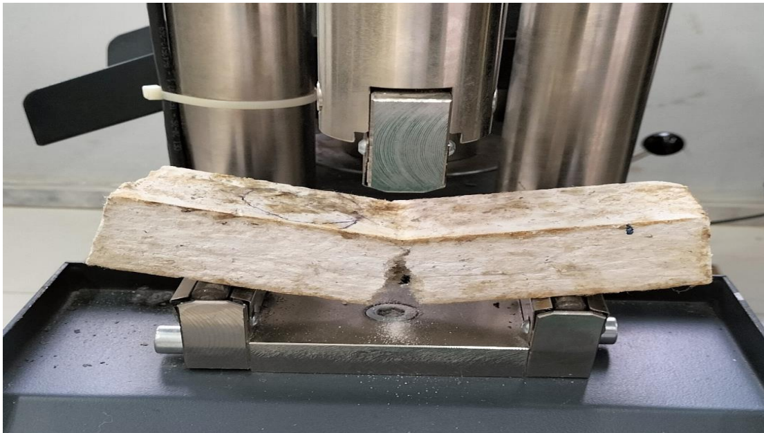
Figure III.6 : Schéma type de l'essai de flexion
