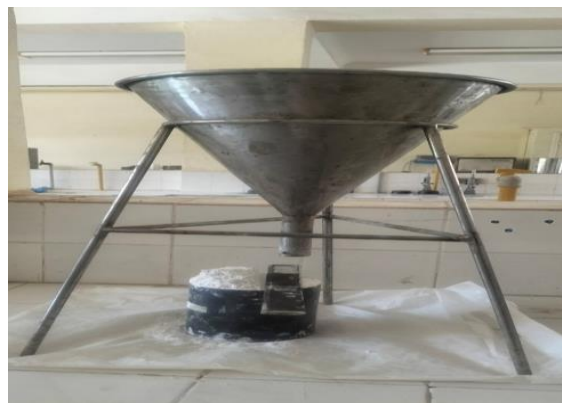
Figure II. 3: Mesure de la masse volumique apparente du plâtre
