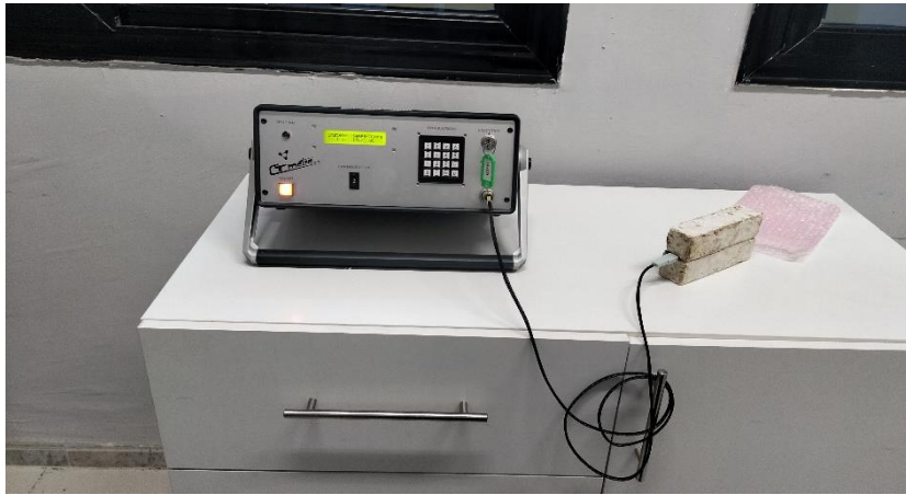
Figure III.10 : L'appareil de CT. Mètre muni d'une sonde à fil chaud
