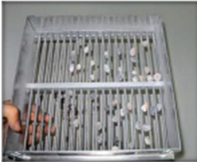
**Figure II.10:** Les granulats plats passant à travers la grille.
