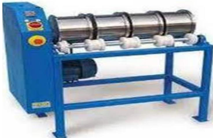
**Figure II.5:** Machine de l'essai Micro-Deval.
