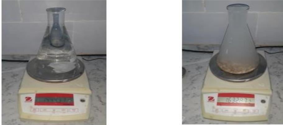
Figure II.14: la masse volumique par la méthode du ballon
