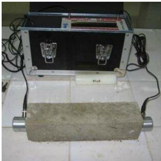
**Figure II.20:** Essai ultrason sur l'éprouvette de béton
