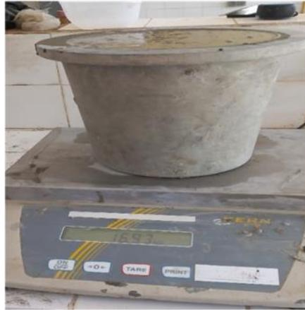
Figure IV.4: Dispositif de mesure de la masse volumique
