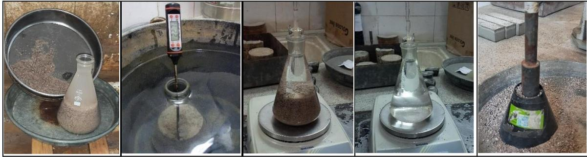
**Figure 2. 12:** Détermination de masse volumique absolue du sable.
