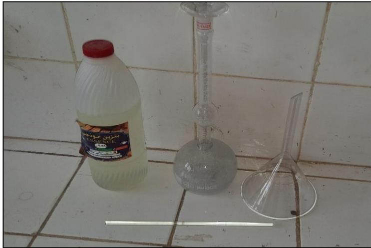
Figure 2. 4:Matériel utilisé pour l'essai de masse volumique absolue du ciment.
