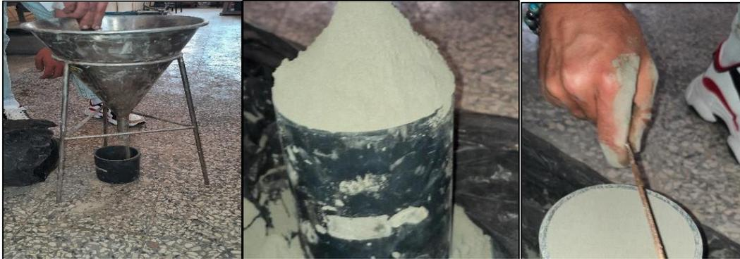
Figure 2. 3: Détermination de la masse volumique apparente du ciment.
