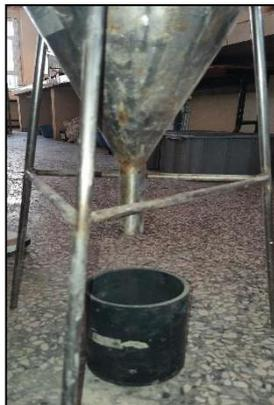
Figure 2. 2: essai de la masse volumique apparente.
