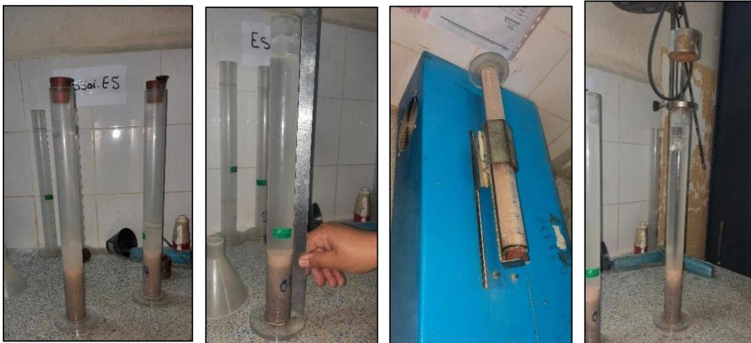
Figure 2. 10: Essai d'équivalent de sable.
