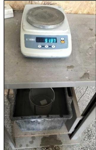
Figure 3.12: Pesée hydrostatique.
