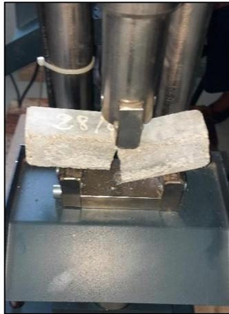
**Figure 3. 15:** Essai de résistance à la flexion.
