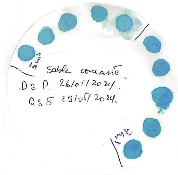
Figure 2. 11: Essai au bleu de méthylène.
