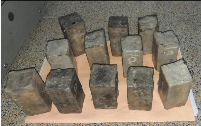
Figure 3.13: Eprouvettes couvertes de paraffine.
