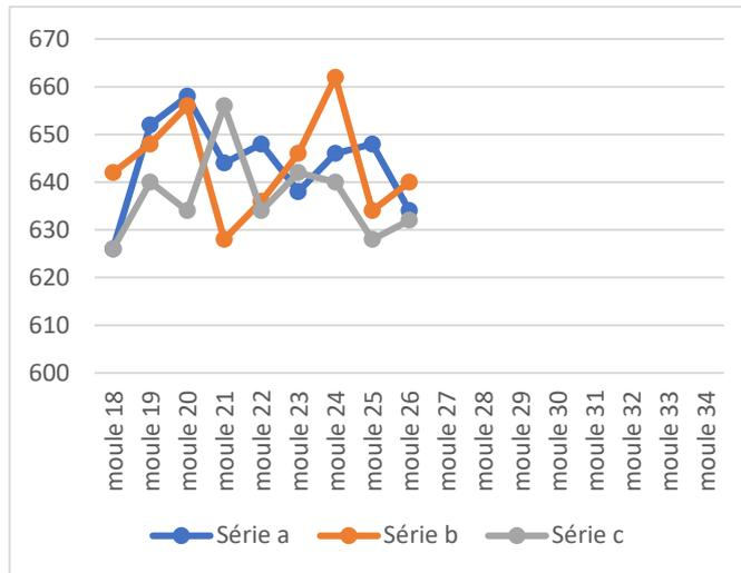
Figure 4. 2: Poids des éprouvettes après 1jour de murissement.
