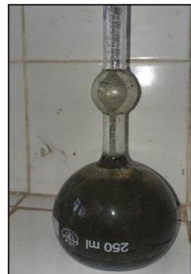
Figure 2. 4: Essai de volume absolu du ciment.
