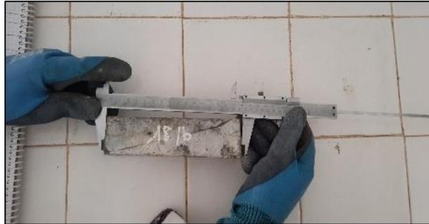
**Figure 3. 9:** Mesure des dimensions des éprouvettes avec un pied à coulisse.
