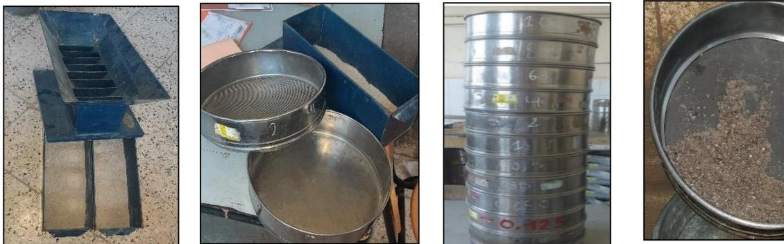
Figure 2. 8: Analyse granulométrique.
