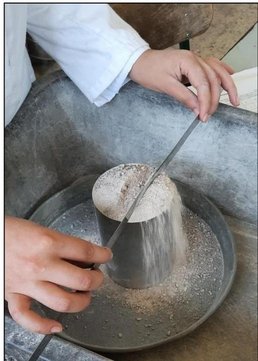
Figure 2. 13: Mesure de la masse volumique apparente.
