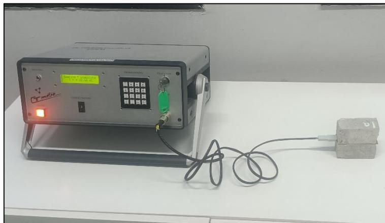
Figure 3.14: conductimètre.
