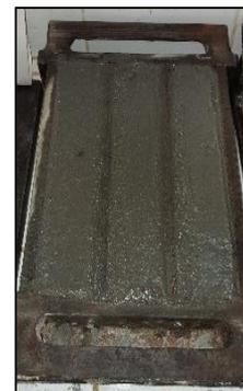
**Figure 3. 3:** Confection des éprouvettes.
