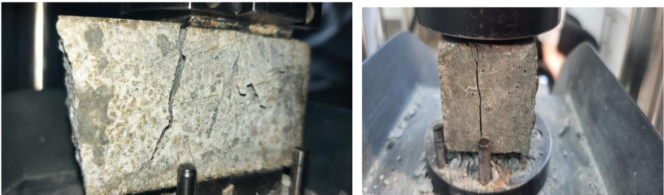
**Figure 3. 16:** Essai de résistance à la compression.
