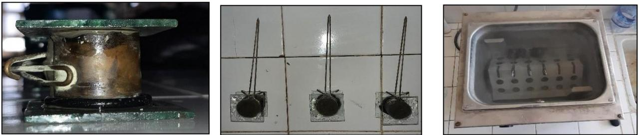
Figure 2. 7: Essai d'expansion du ciment.
