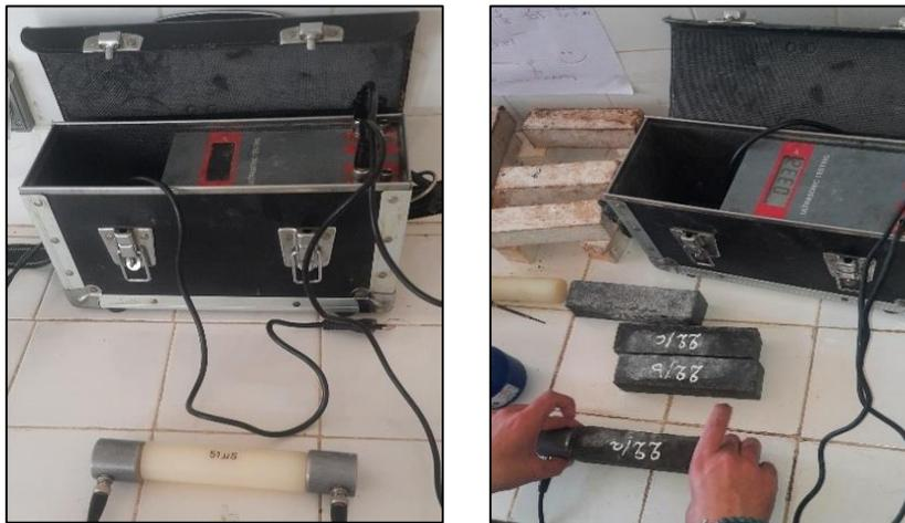
Figure 3. 8: Essai par ultrason.
