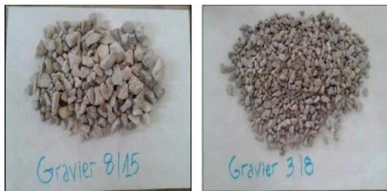
*Figure I. 8 : Les deux fractions de graviers (3/8, 8/15).[15]*
