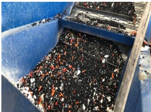
*Figure I. 10 : Plastique recyclé et broyé.[18]*
