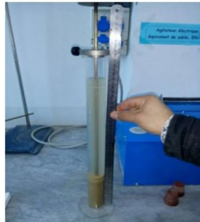
Figure III. 3.2 : Essai équivalent de sable
