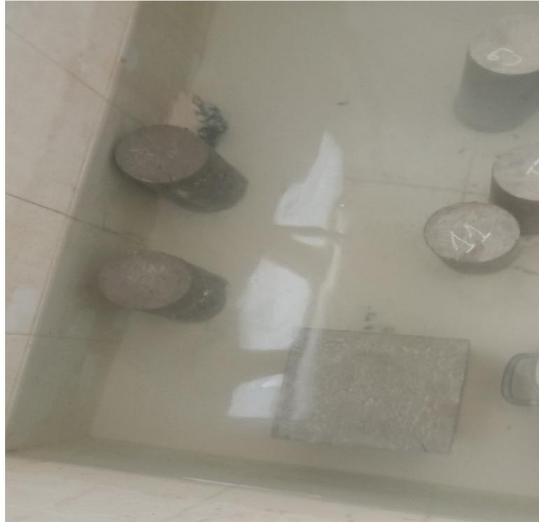
*Figure II.20 : Bague de conservation des éprouvettes.*
