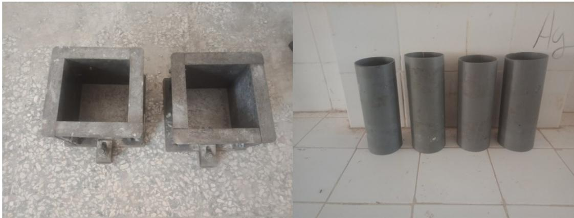
*Figure II.18 : Les moules cubique et cylindrique.*
