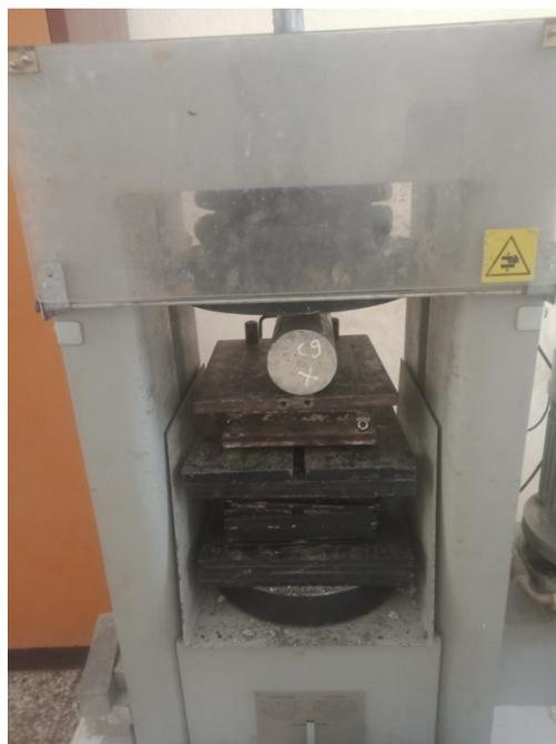
*Figure II.14 : Essai par fendage.*
