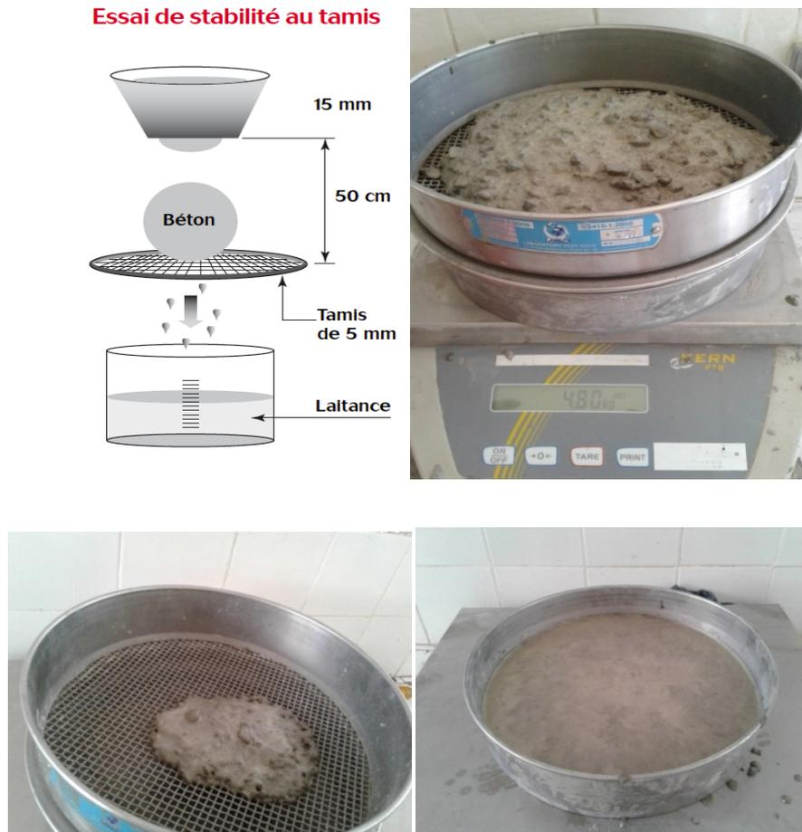
*Figure II.11 : Essai de stabilité au tamis.*
