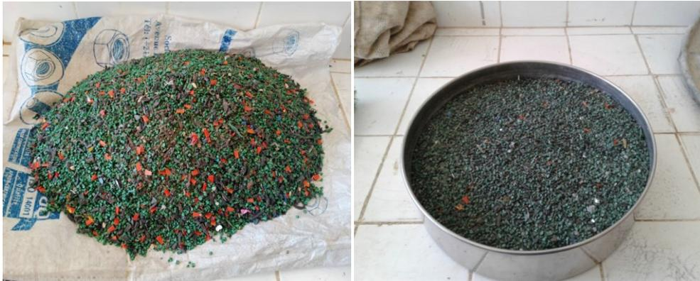
*Figure II.7 : Plastique recyclé broyé.*
