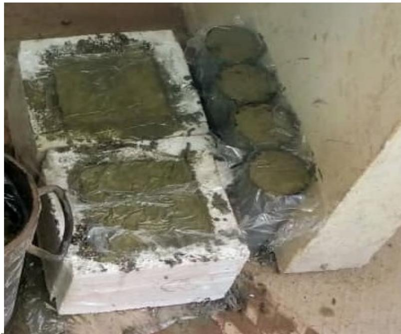
*Figure II.19 : Remplissage des moules.*
