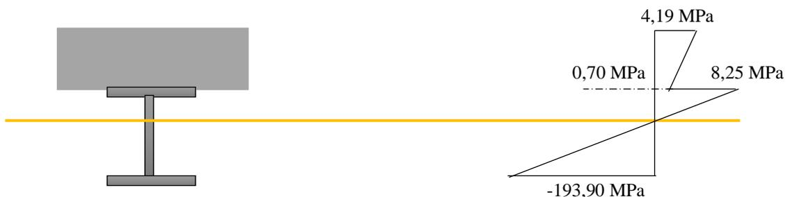
Figure 4-15 : Diagramme des contraintes de flexion simple
