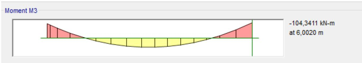
Figure V.10 Moment sollicitant négatif de la poutre de l'étage courant (ETABS)
