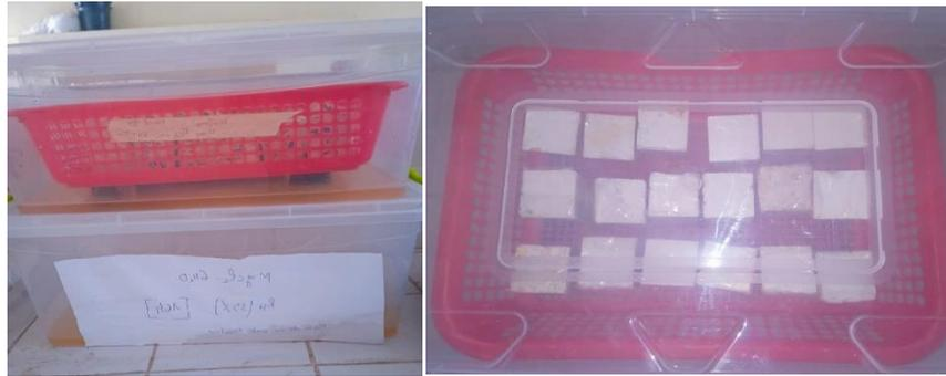
**Figure 2- 28 : Essai MBV**
