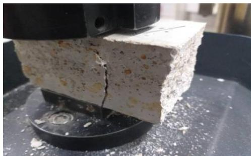
Figure 2- 25 : Essai de résistance à la compression
