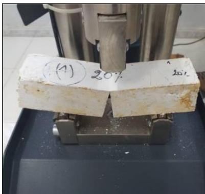
Figure 2- 23 : Essai de résistance à la flexion
