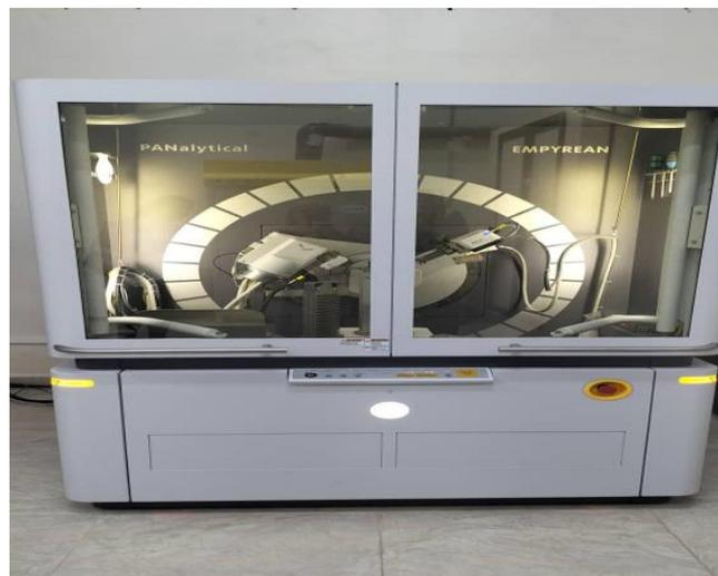
**Figure 2- 10 : appareil DRX**
