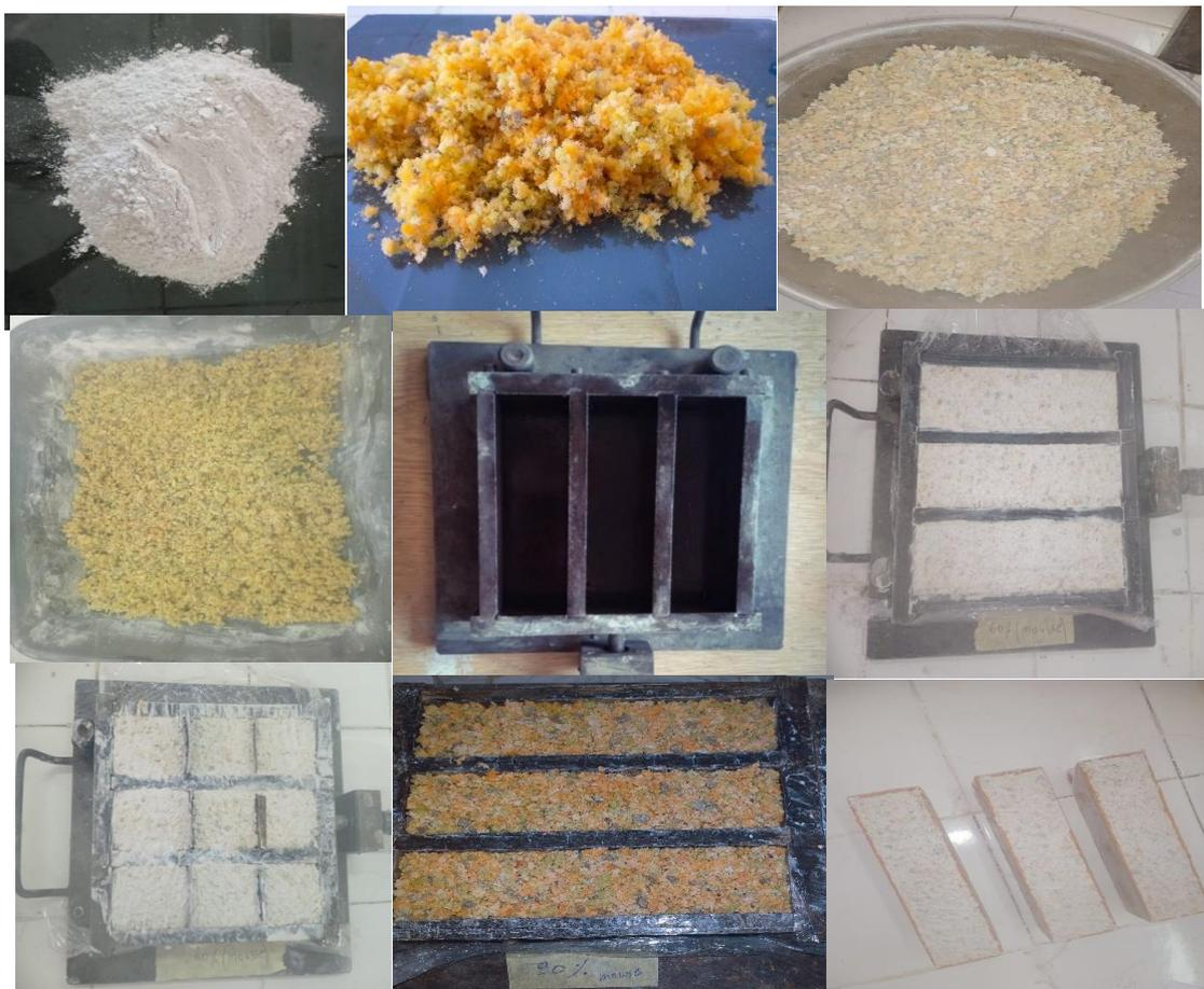
**Figure 2- 17 : Fabrication et conservation des pâtes de plâtre avec/sans la mousse polyuréthane**
