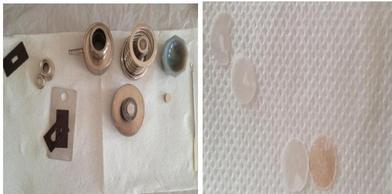
**Figure 2- 13 : Préparation de la pastille pour essai Infrarouge**
