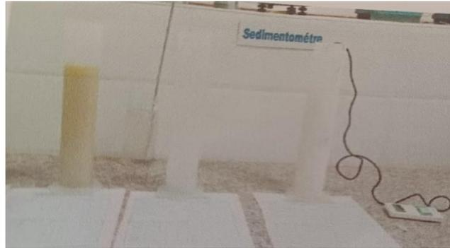
Figure 2- 5 : L'essai sédimentométrique
