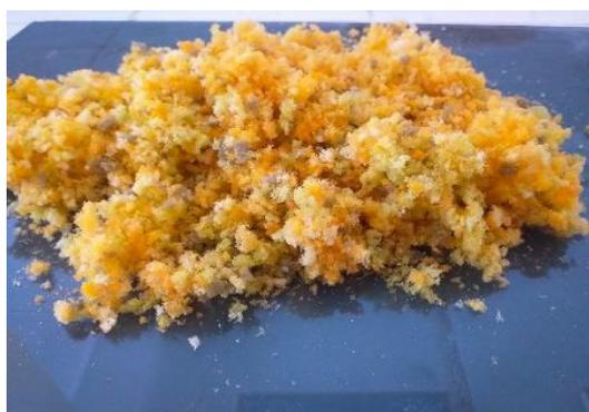
**Figure 2- 8 : Les broyats de déchets de mousse polyuréthane**
