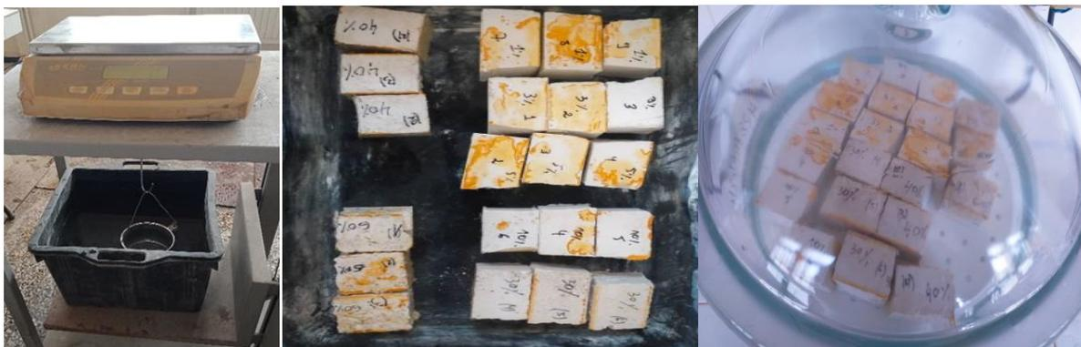
Figure 2- 20 : Procédures des essais de porosité, densité et absorption d'eau
