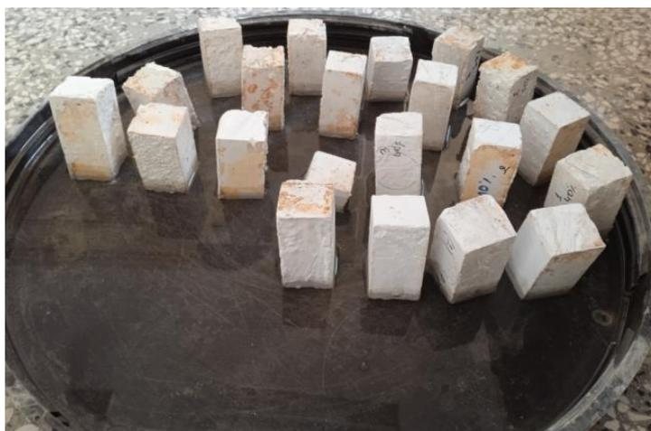
Figure 2- 5 : Essai d'absorption d'eau par capillarité
