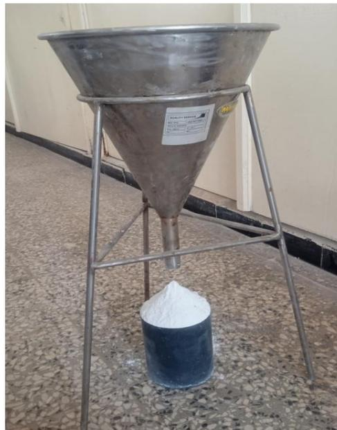
**Figure 2- 1 : Masse volumique apparente.**
