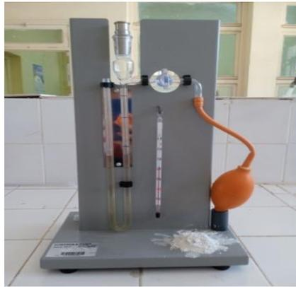
**Figure 2- 7 : Perméabilimètre de BLAINE**
