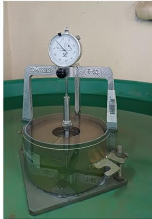
FIGURE 2.24 – Imbibition et mesure au comparateur du gonflement.
