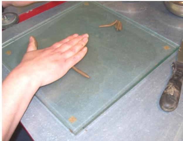
FIGURE 2.6 – Détermination de la limite de plasticité.
