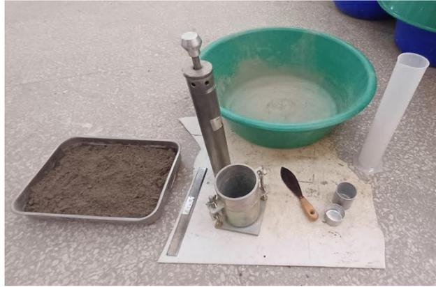
FIGURE 2.11 – Vue générale de l'équipement de l'essai Proctor Normal.
