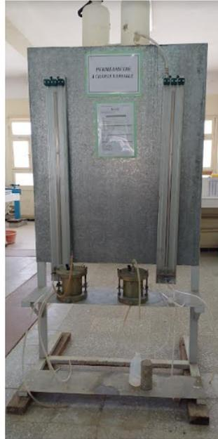
FIGURE 2.9 – Appareils de perméamètres.
