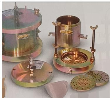
FIGURE 2.10 – Vue générale de l'équipement de perméabilité.
