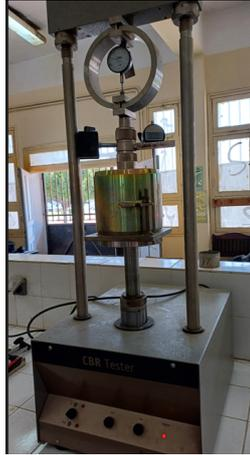
FIGURE 2.20 – Opération de poinçonnement.
