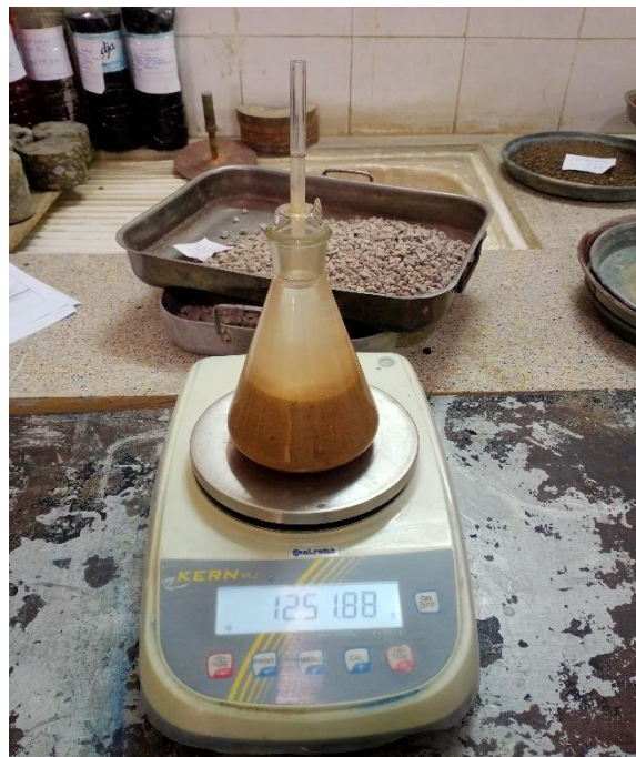
Figure II.11 Essai du pycnomètre
