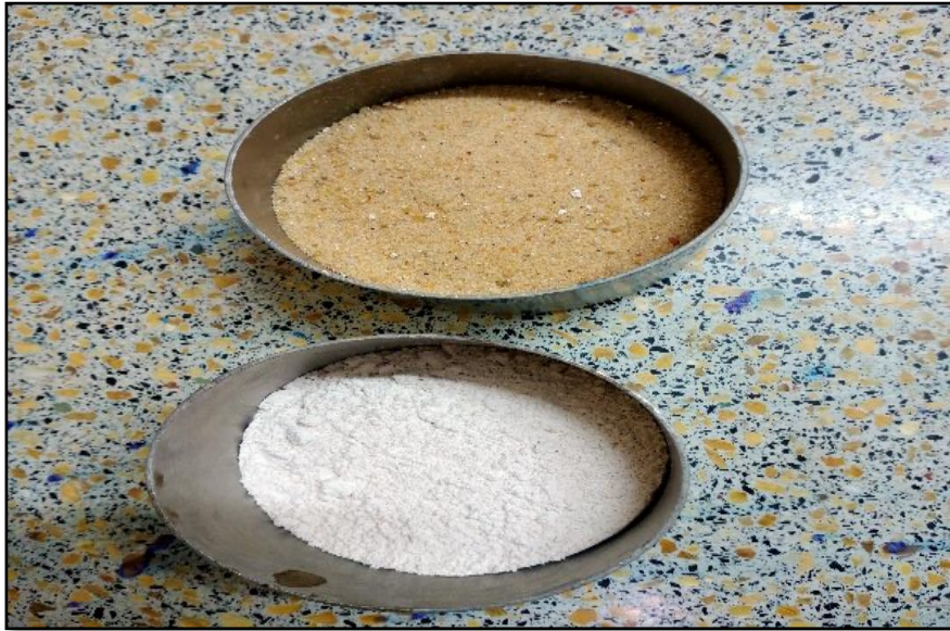
Figure II.8 Essai ES (sable + kaolinite).
