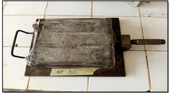
Figure II.28 Couverture des moules avec du film Plastique.
