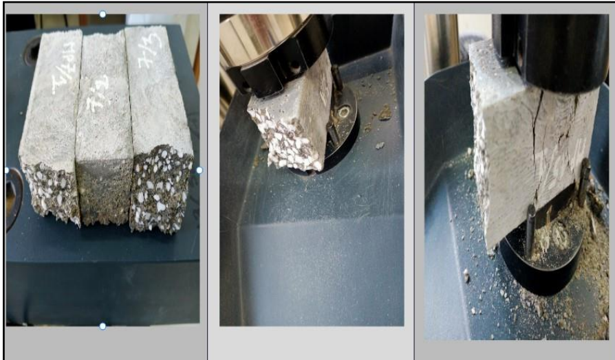
Figure II.35 Epreuve de mortier soumis aux tests de compression.
