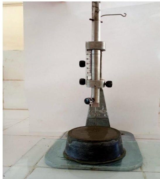
Figure II.20 Appareil de Vicat muni de l'aiguille
