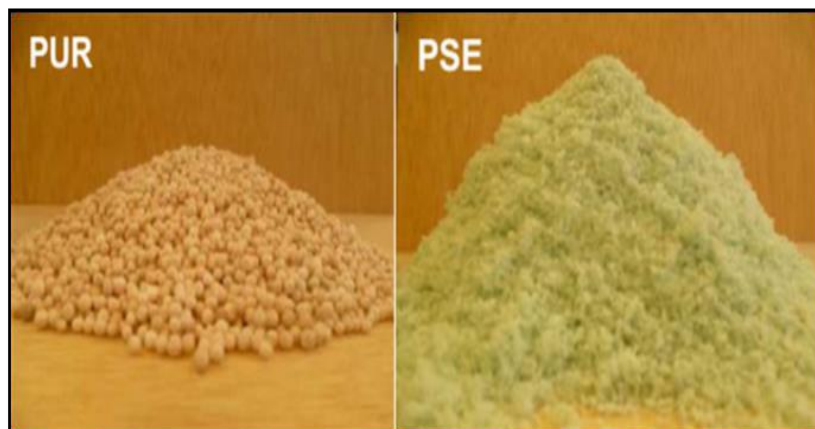
Figure I.16 Mousse de polyuréthane extrudé rigide et de polystyrène expansé utilisées.
