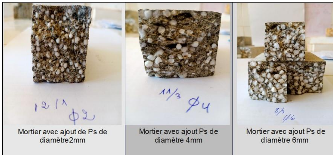
Figure III.21 L'ajout de Polystyrène avec différents diamètres.
