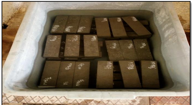
Figure II.29 Conservation des éprouvettes dans l'eau après démoulage.
