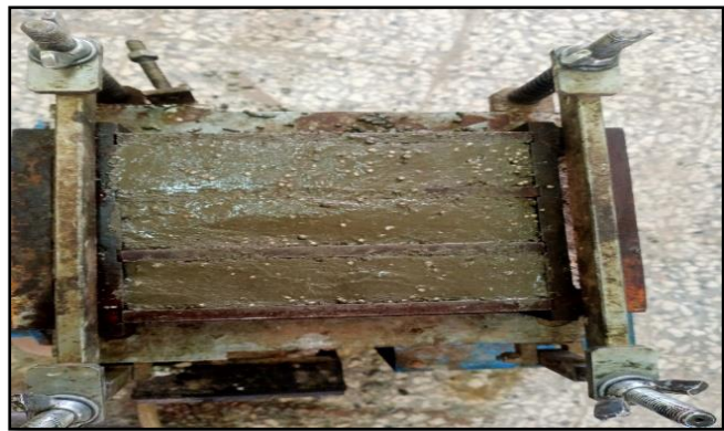
Figure II.26 Coulage du mortier.
