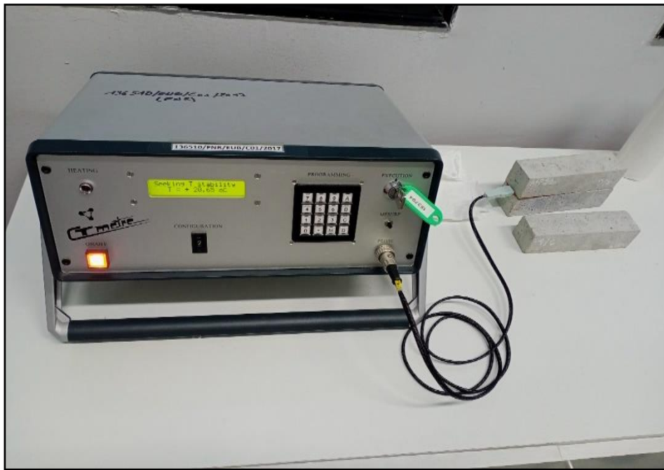
Figure III.10 Essai de conductivité thermique.
