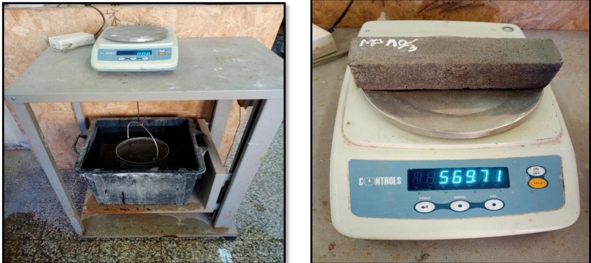
Figure II.30 La pesé hydrostatique sature et sous l'eau.
