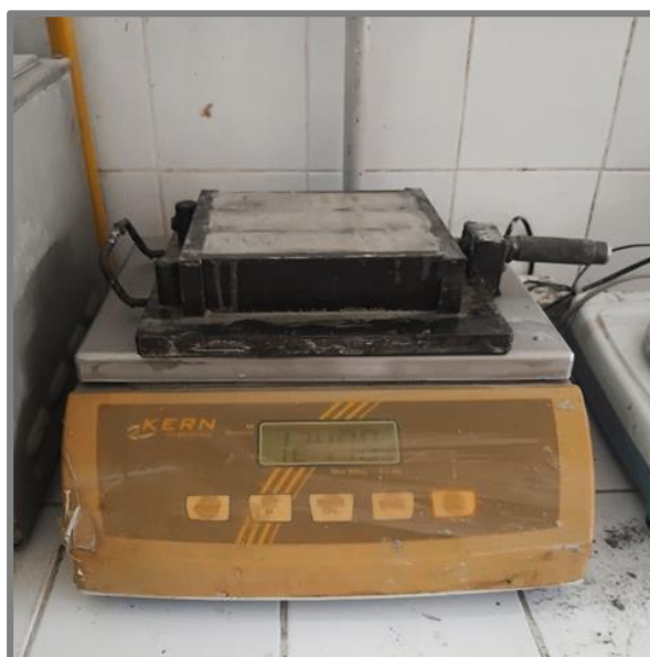
Figure IV-3: Mesure de la masse volumique à l'état frais.
