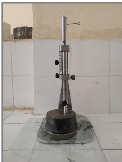
Figure III-8: Mesure de la consistance de ciment.
