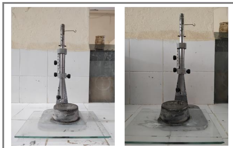
Figure III-9: Mesure de l'essai de prise du ciment (Heures de Début et de Fin de Prise).
