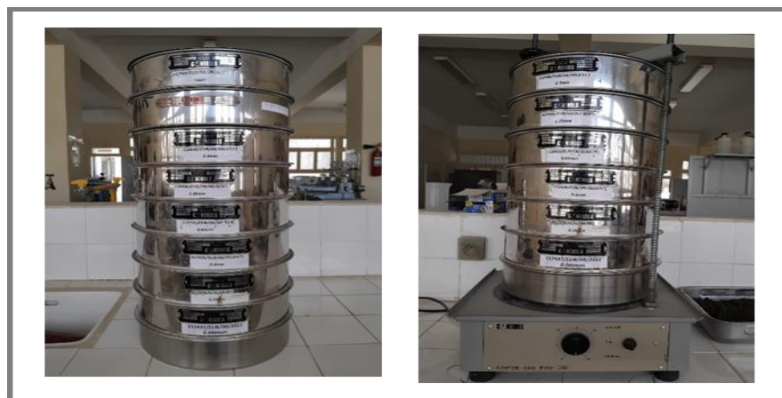
Figure II-6: La colonne des tamis utilisés.
