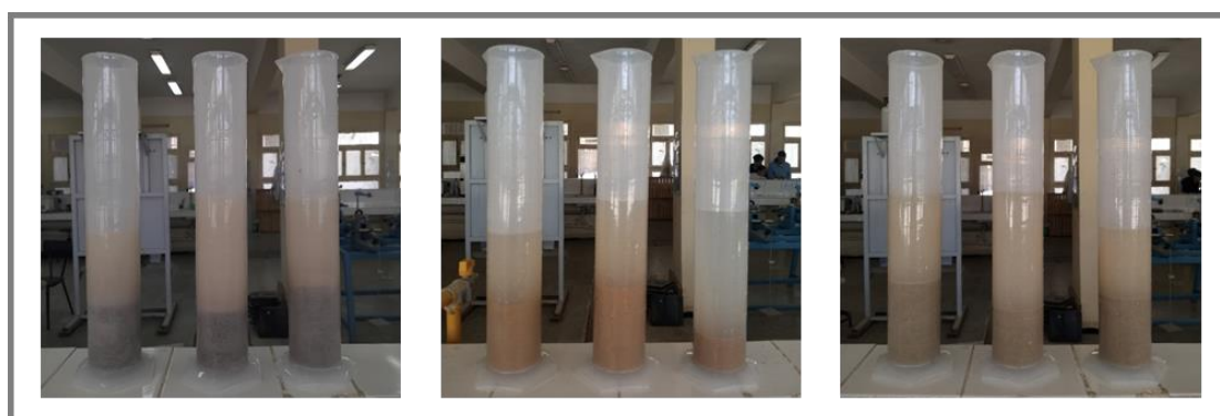
Figure III-2: Mesure de la masse volumique absolue.
