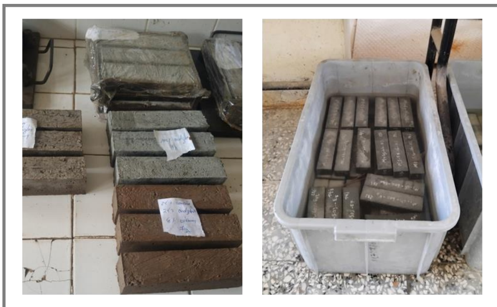
Figure IV-2: Mode de conservation des éprouvettes.
