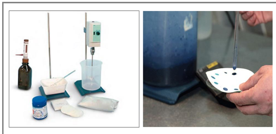
Figure II-8: L'essai au bleu de méthylène.
