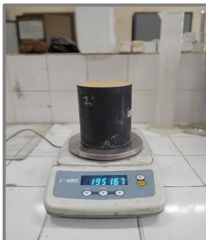
Figure III-1: Mesure de la masse volumique apparente.
