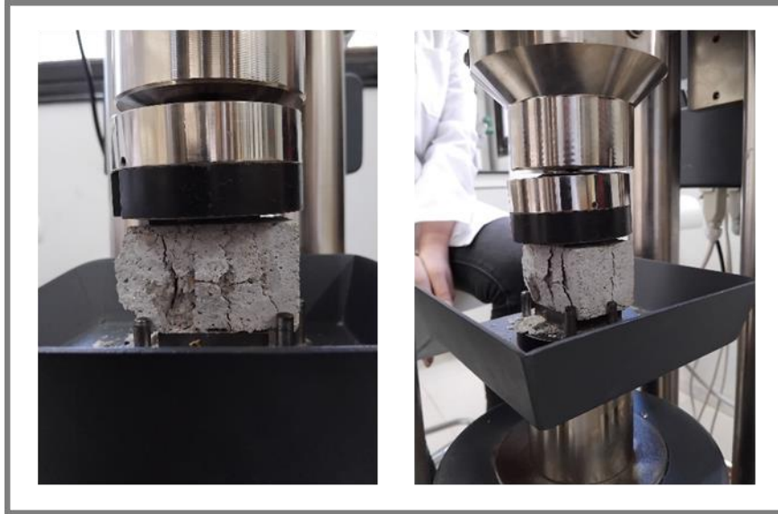
Figure IV-8 : L'écrasement d'éprouvette à l'essai de compression.
