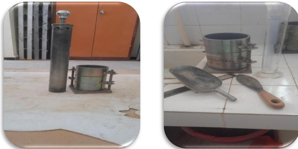
**Figure II.9 :** Appareillage de l'essai Proctor normal
