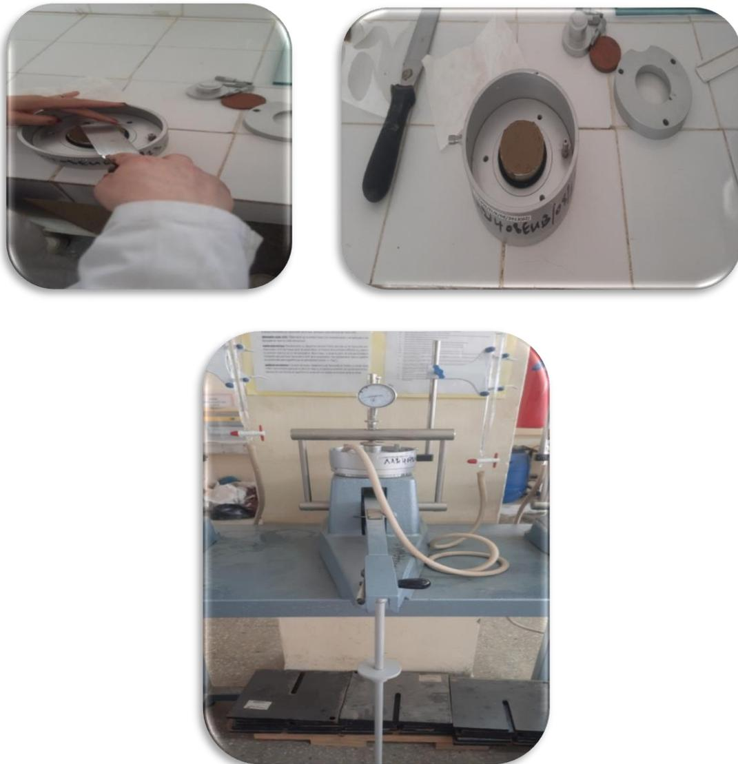
**Figure II.11** : Appareillage et mode opératoire de l'essai œdométrique
