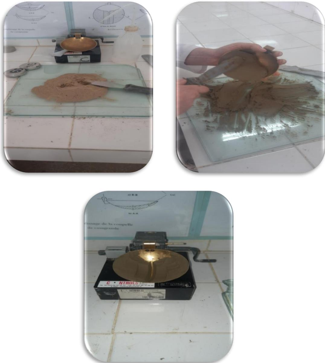
**Figure II.7 :** Mode opératoire de l'essai de la limite de liquidité
