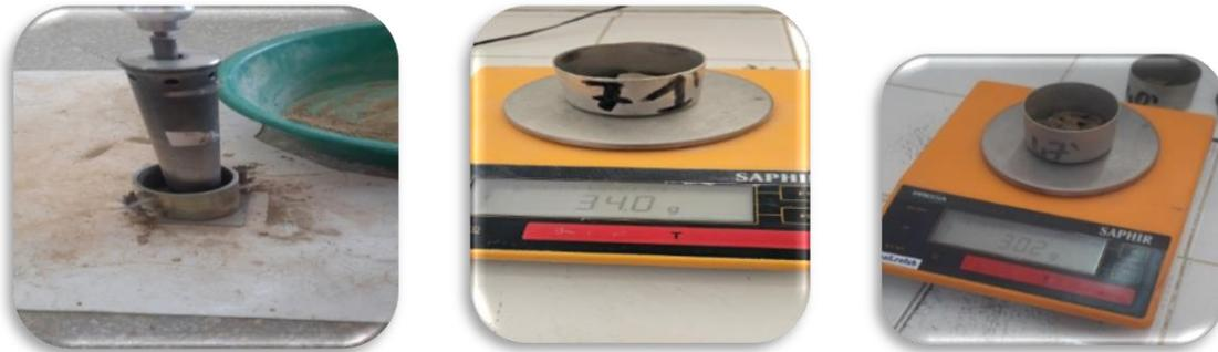
**Figure II.10 :** Mode opératoire d'essai Proctor normal
