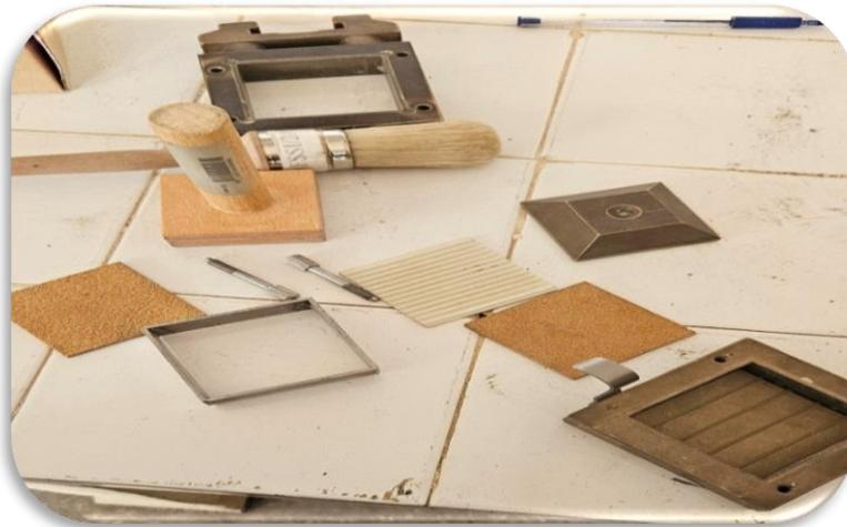
Figure II.12 : Appareillage de l'essai cisaillement à la boîte
