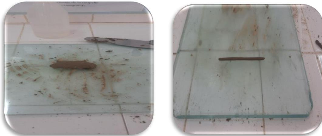
**Figure II.8** : Mode opératoire d'essai limite de plasticité
