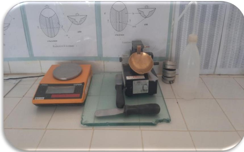
**Figure II.6 :** Appareillage d'essai limite d'Atterberg
