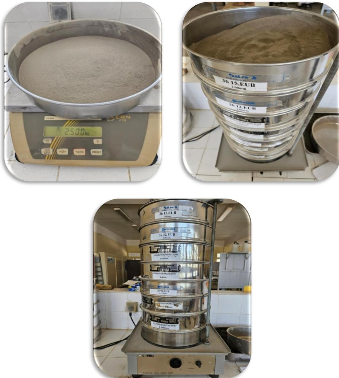
Figure II.5 : Essai d'analyse granulométrique
