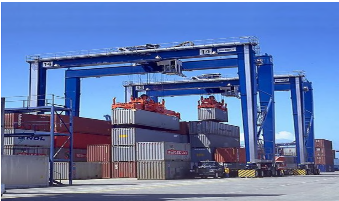
FigureN°05 : les rubber-tyred gantry cranes
