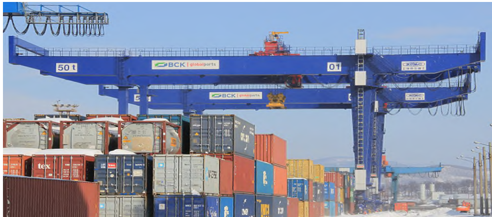
Figure N°04 : Les rail-montés gantry cranes
