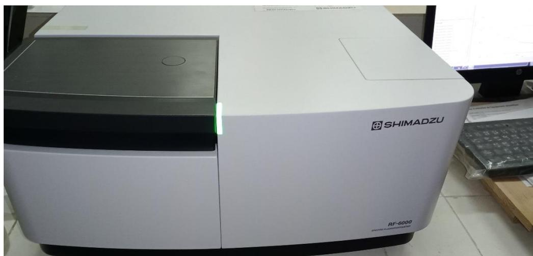
**Figure II. 13** : Spectromètre de photoluminescence.
