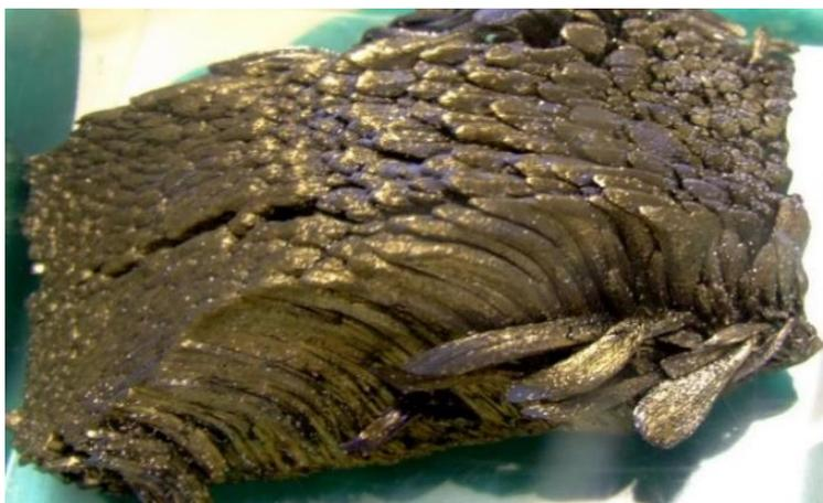
**Figure I. 5 :** Europium sous forme de lingot pur à 99,998 % [39].
