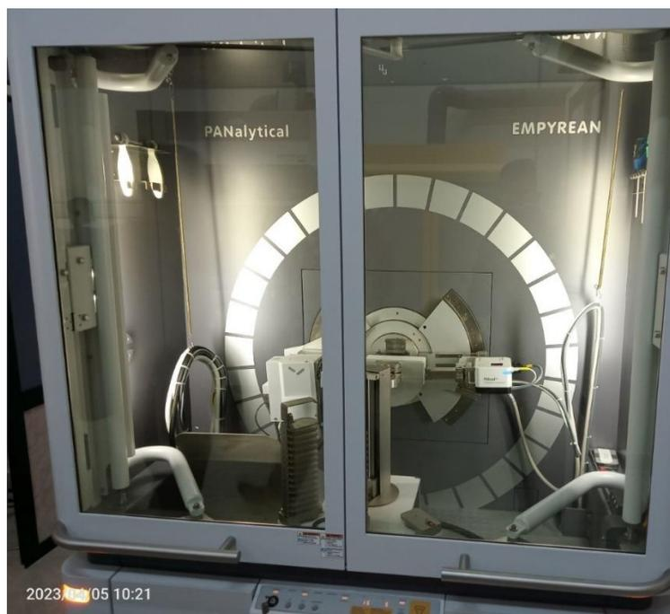
**Figure II. 8 :** Diffractomètre PANalytical Empyrean utilisé.
