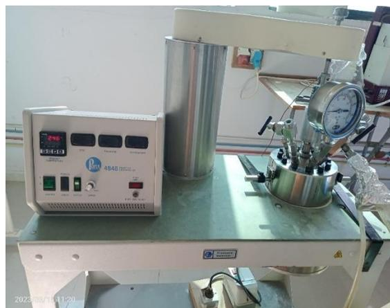
Figure II. 5 : Autoclave utilisé.
