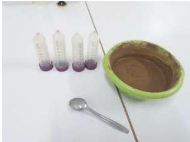
**Figure 10 : Préparation de la pâte saturée.**
