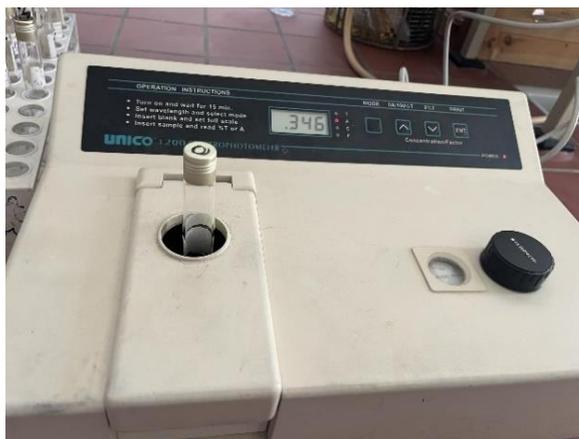
**Figure 9** : Spectrophotomètre utilisé pour évaluer la densité optique
