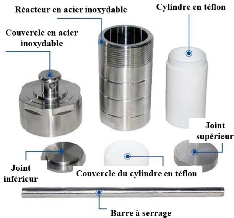
Figure III. 1: Les composantes principales d'un autoclave.
