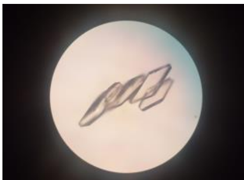
Figure IV. 13: Photographie des cristaux à base d'Yb vus sous microscope optique.
