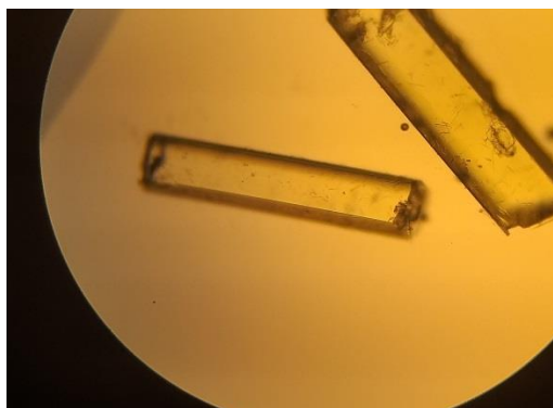
Figure V. 1: Photographie des cristaux à base d'Ho vus sous microscope optique.
