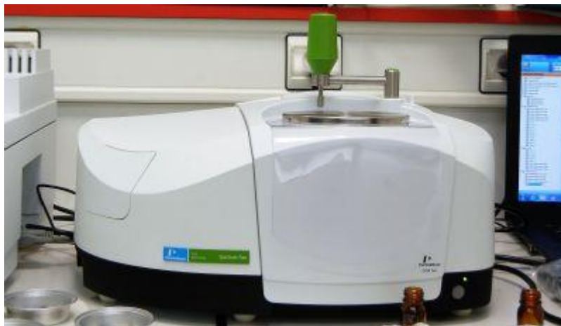
Figure III. 6: spectromètre PerkinElmer Spectrum 2 FT-IR ATR.
