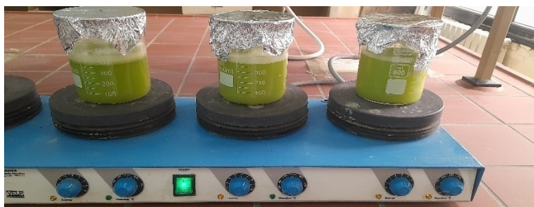
Figure 07 : Extraction conventionnelle du mucilage avec agitation.
