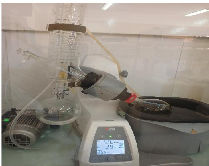
**Figure 13.** Concentration des extraits à l'aide d'un rotavapor.
