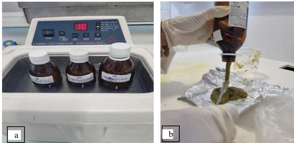
**Figure 12.** Extraction des CPT par ultrasons. Bain ultrasons (a), récupération de l'extrait d'éther de pétrole (surnageant) et formation d'une gomme (culot) après extraction (b).
