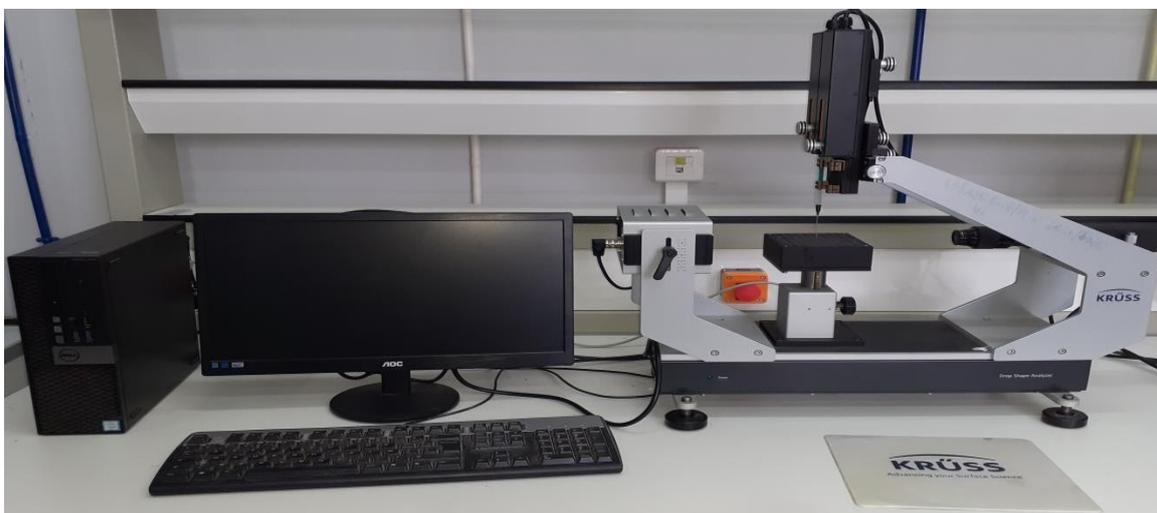
**FigureV.6:** L'appareil de mesure d'angle de contact
