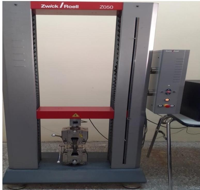
**Figure V.4:** Machine de traction Zwick-Roell de type Z050
