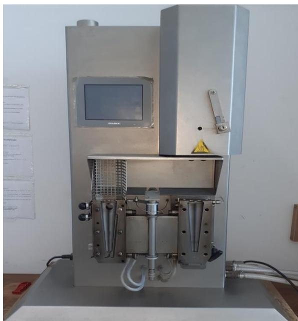
**FigureV.1:** Extrudeuse bi-vis de type micro 15cc Twin Screw Compouder
